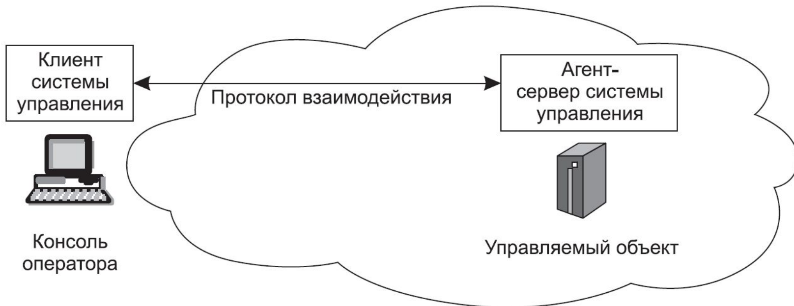
Рис. 25.1. Двухзвенная схема управления устройством
