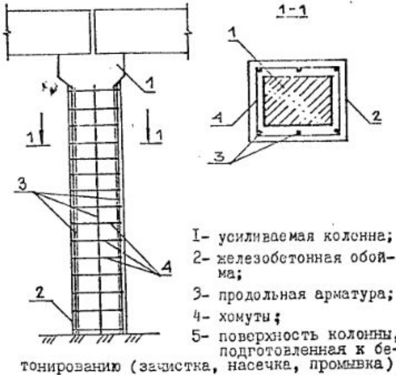
УСТРОЙСТВО ЖЕЛЕЗОБЕТОННОЙ ОБОЙМЫ
