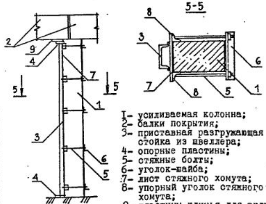
УСТАНОВКА ПРИСТАВНЫХ РАЗГРУЖАЮЩИХ СТОЕК
