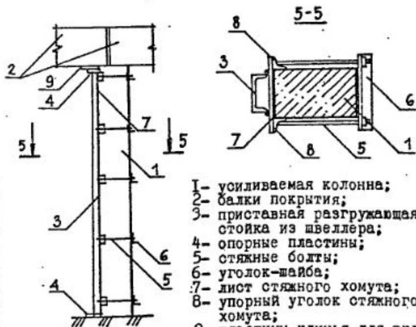
УСТАНОВКА ПРИСТАВНЫХ РАЗГРУЖАЮЩИХ СТОЕК
