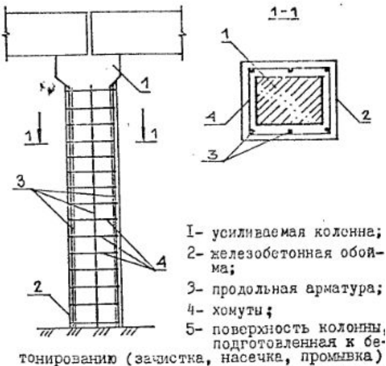
УСТРОЙСТВО ЖЕЛЕЗОБЕТОННОЙ ОБОЙМЫ
