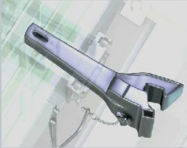
Автосцепка с деталями механизма
