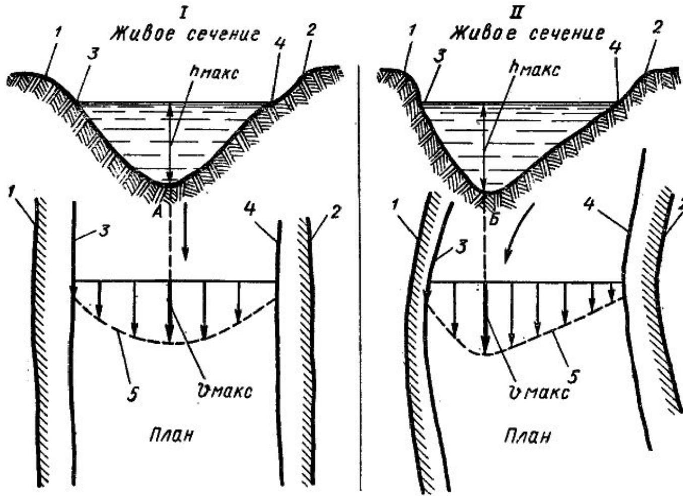
Рис. 1. Распределение поверхностных скоростей течения в плане:
