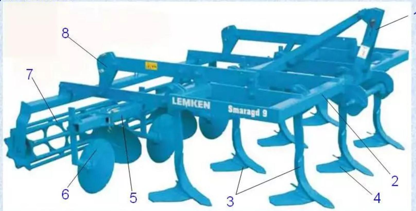
1-трехточечная навеска; 2-рама; 3-два ряда лап; 4-лапа; 5- ряд сферических дисков; 6-выдвижные крайние диски; 7- трубчатый каток; 8- плита настройки глубины
