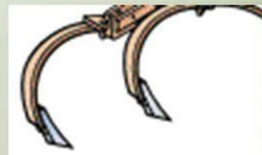
Долотообразные наральники рыхлительных лап имеют две режущие кромки с углом раствора 60...70°. Наральники закреплены на пружинных или жестких стойках. Двусторонние наральники после износа одного конца поворачивают на 180°.
