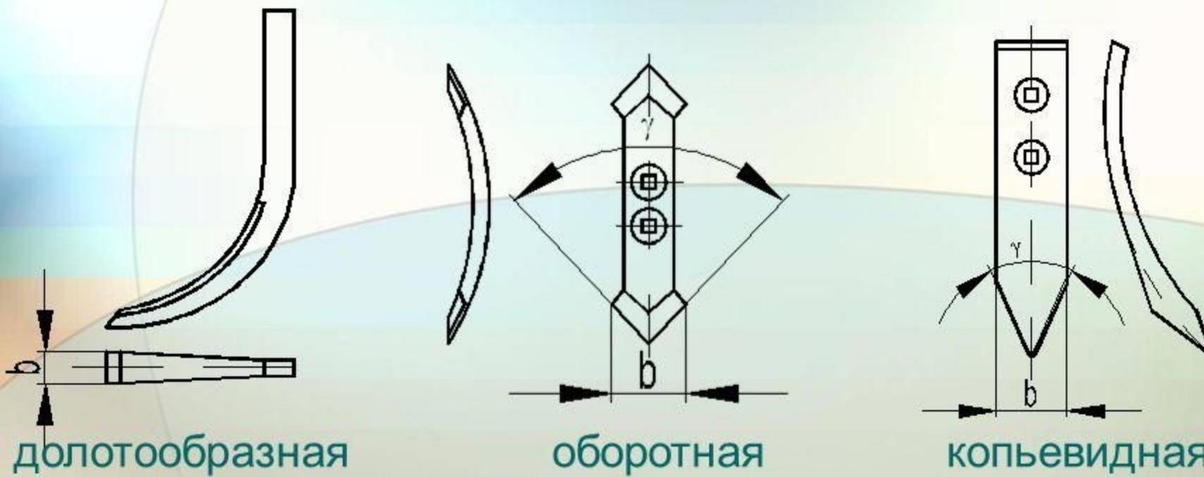
Лапы с пружинными стойками шириной захвата 20...50 мм служат для рыхления почвы на глубину до 16 см, вычесывания корнеотпрысковых сорняков, культивации почвы повышенной влажности. Во время работы они вибрируют и самоочищаются от нависших на стойки растительных остатков.
