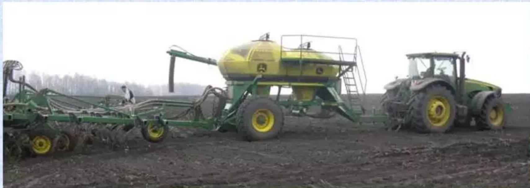
**Сеялка 730 с двухдисковым сошником используется при работе по минимальной и классической технологиям обработки почвы. Данная модель сеялки совместима с зерновым прицепом 1910. За один проход этой сеялки проводится не только посев, но и одновременно культивация и внесение удобрений**
