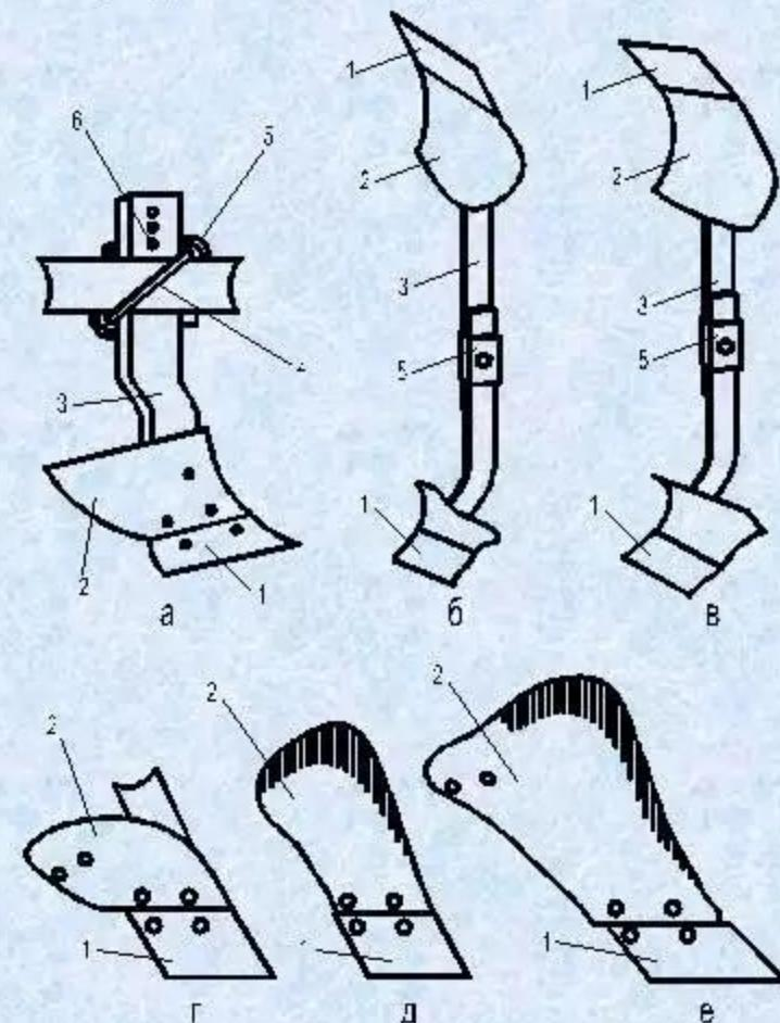
Нож плуга разрезает почву в вертикальной плоскости по линии отделения пласта от массива и способствует лучшему обороту пласта, заделке растительных остатков, обеспечивает устойчивый ход плуга и равномерность глубины вспашки. Различают ножи дисковые, черенковые и плоские с опорной лыжей.
