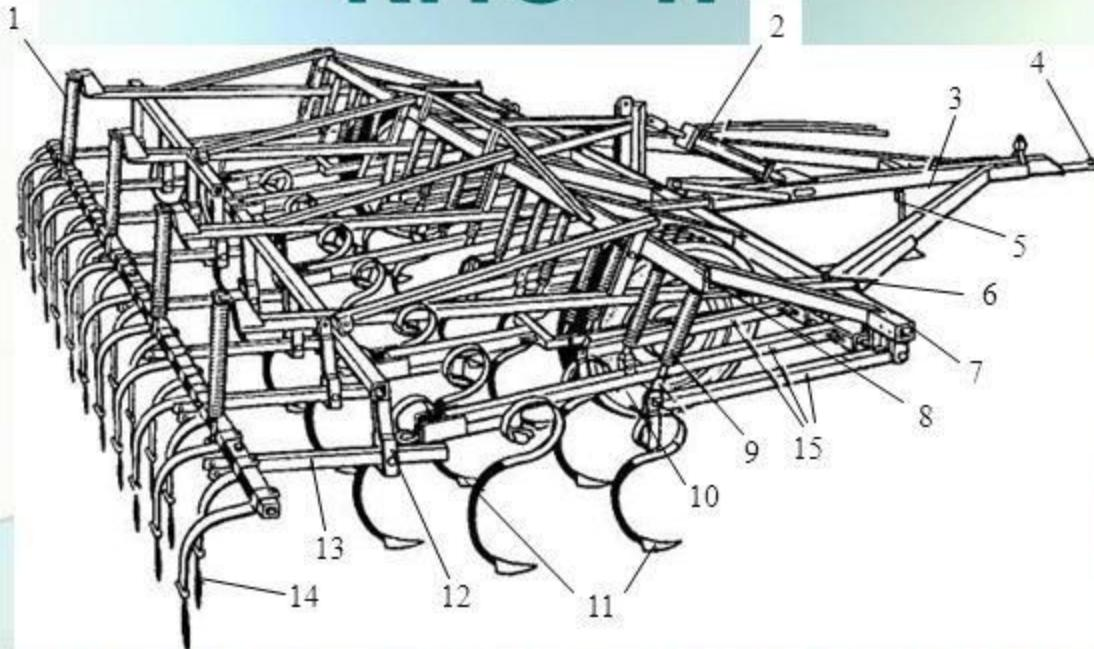
1—пружина; 2—гидроцилиндр; 3—сница; 4—серъга; 5—подставка; 6—регулятор глубины; 7—рама; 8—угольник; 9—штанга с пружиной; 10—колесо; 11—рабочие органы; 12—понизитель; 13—приспособление для навески борон; 14—зубовая борона
