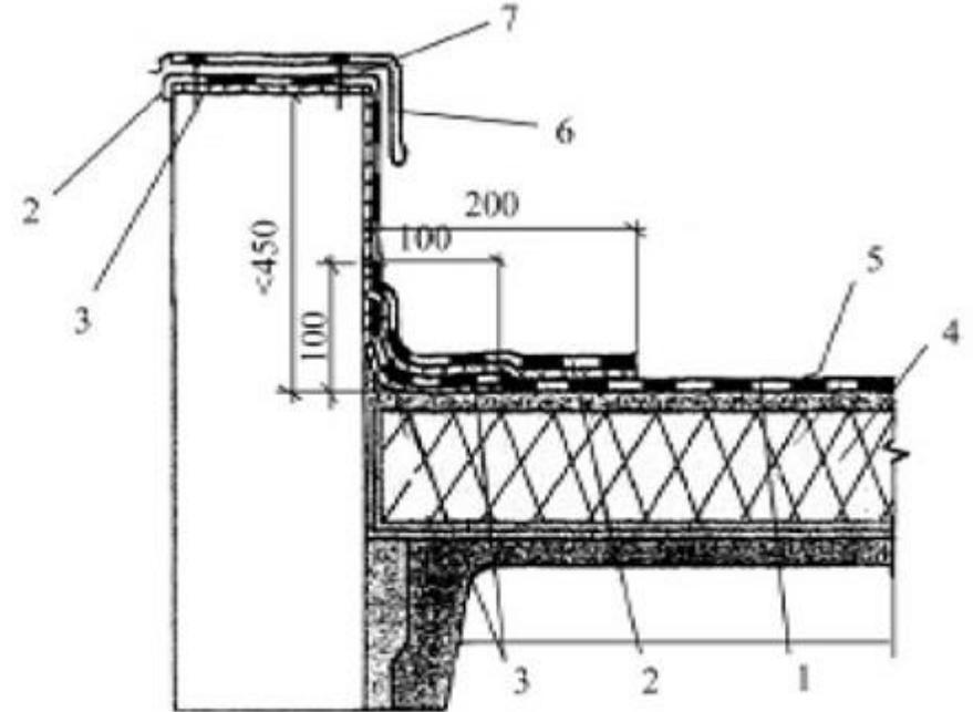
Рис. 9. Примыкание кровли к парапету высотой до 450 мм:
