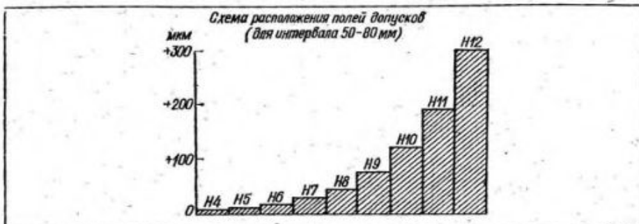
1.27. Система отверстия. Предельные отклонения основных отверстий при размерах до 500 мм (по СТ СЭВ 144—75)
