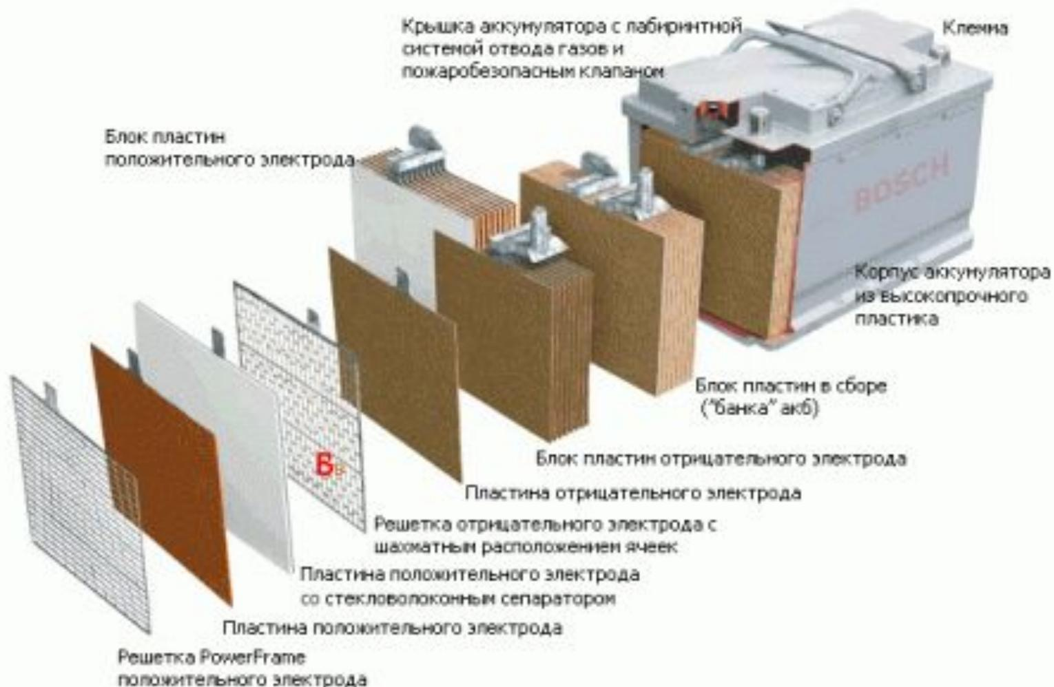
Принципиальная конструкция автомобильного аккумулятора Bosch с использованием технологии AGM
