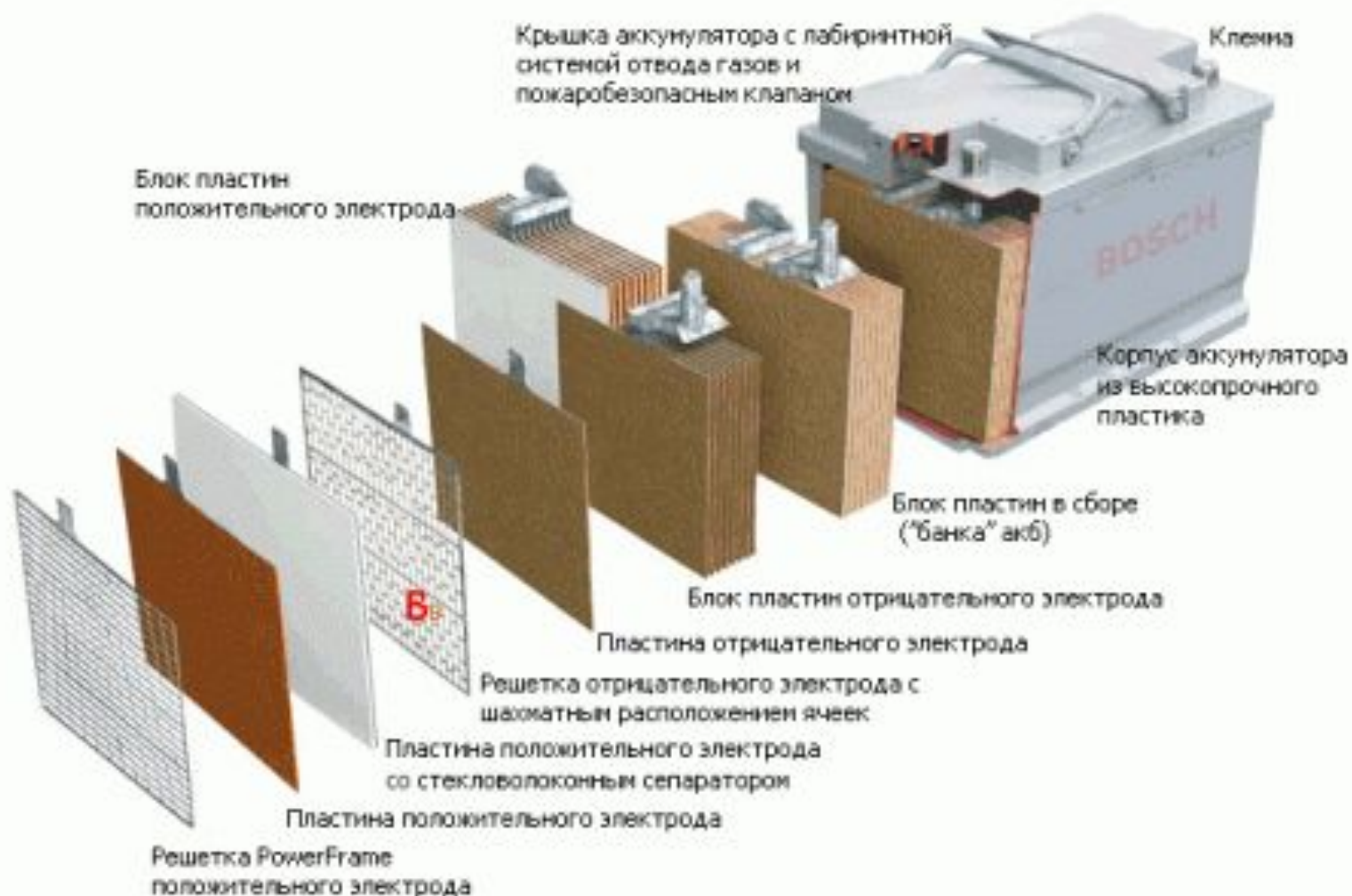
Принципиальная конструкция автомобильного аккумулятора Bosch с использованием технологии AGM
