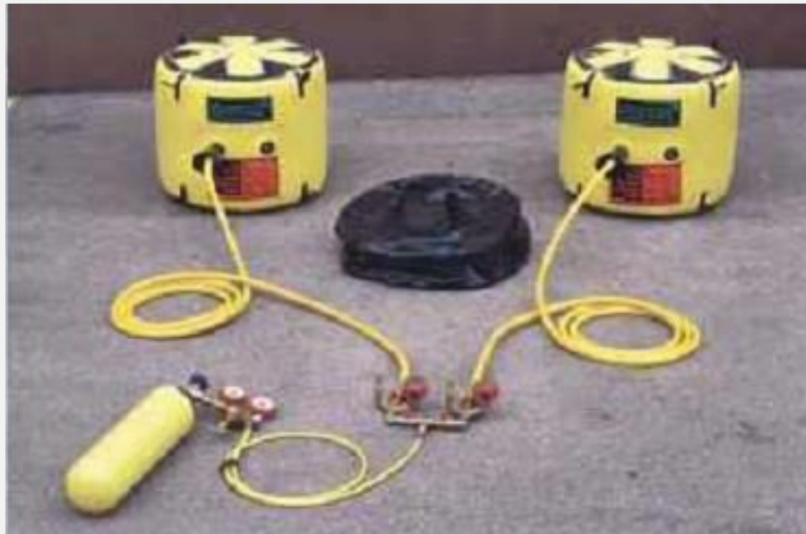
Rysunek nr 16. Złożony zestaw ratowniczy pneumatyczny niskociśnieniowy [1,2,3].
