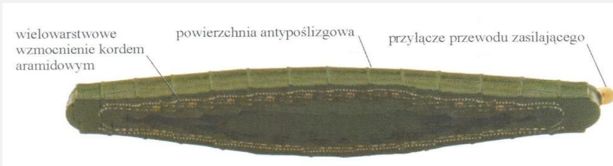
Rysunek nr 6. Budowa siłownika pneumatycznego wysokociśnieniowego [1,2,3].
