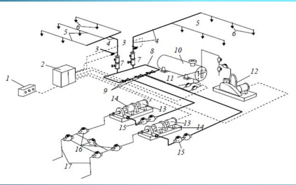
Принципиальная схема спринкерной установки водяного пожаротушения:
