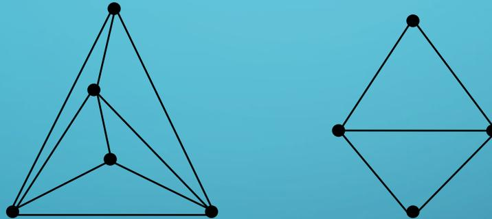
Каждая грань в плоском представлении максимально плоского графа имеет 3 вершины. Поэтому максимально плоский граф называют еще **триангулированным**. Операция добавления новых ребер, в результате которой в плоском представлении каждая грань имеет ровно 3 вершины, называется **триангуляцией** графа. Триангулированные графы с одним и тем же числом вершин могут не совпадать.
