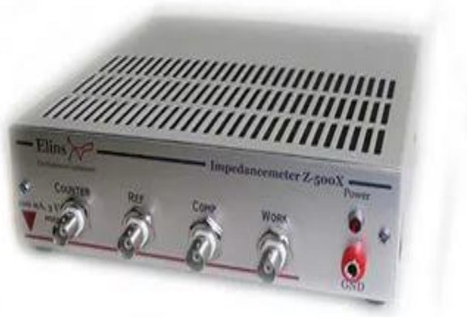
Спектры импеданса регистрировали на импедансометре Элинс Z500P в диапазоне частот переменного тока от 50Гц до 500кГц с амплитудой 100 мВ при нулевом потенциале индикаторного электрода.
