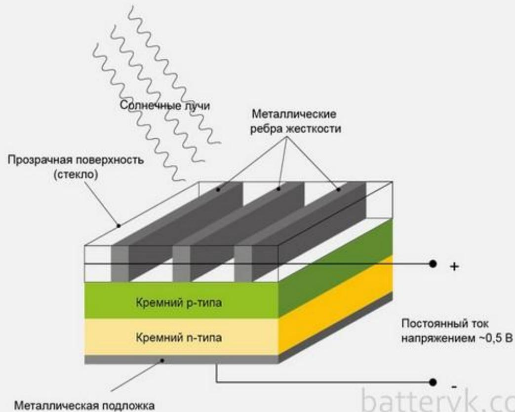
Солнечный элемент - это устройство на основе р-п-перехода, сделанное из полупроводниковых материалов. В большинстве случаев их делают из кремния. На металлическую подложку, служащую одним из контактов, наносятся слои полупроводника р-типа и n-типа, которые образуют р-п-переход. Сверху наносится металлическая пленка, служащая вторым контактом.
