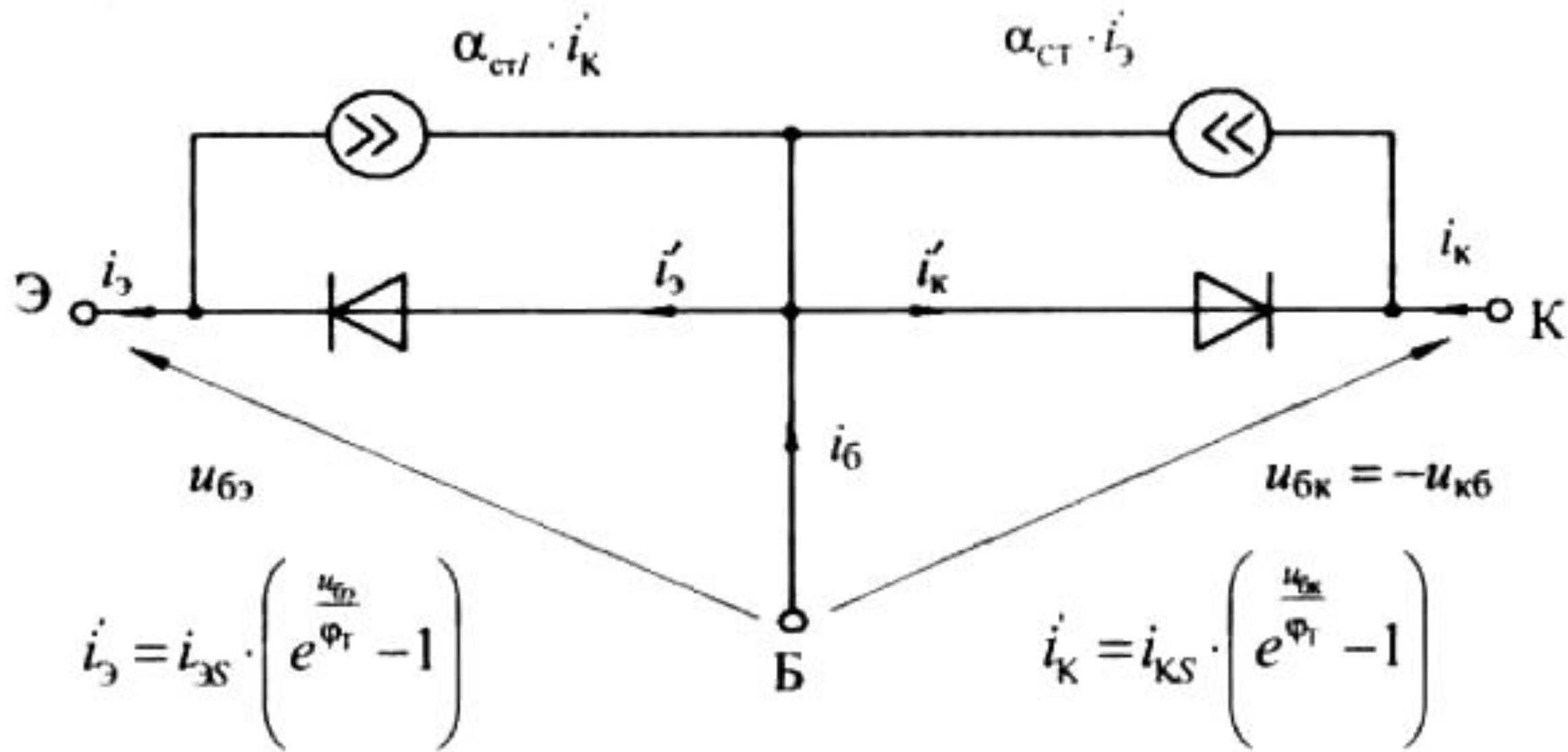
$$i_{\text{э}} = i_{\text{эс}} \cdot (e^{\mu_{\text{эо}} / \varphi_{\text{T}}} - 1) - \alpha_{\text{СТ I}} \cdot i_{\text{кс}} \cdot (e^{\mu_{\text{ок}} / \varphi_{\text{T}}} - 1),$$
