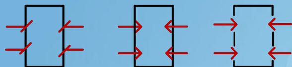
На инверсном динамическом выводе переменная имеет значение 1, если значение на выводе (входе) меняется с 1 на 0.
