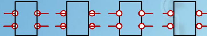
На прямом динамическом выводе переменная имеет значение 1, если значение на выводе (входе) меняется с 0 на 1.
