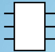
Если входы (выходы) логически не равноценны, то в дополнительном поле напротив каждого входа (выхода) указывают метку, которая условно обозначает функциональное свойство или назначение соответствующего входа (выхода)
