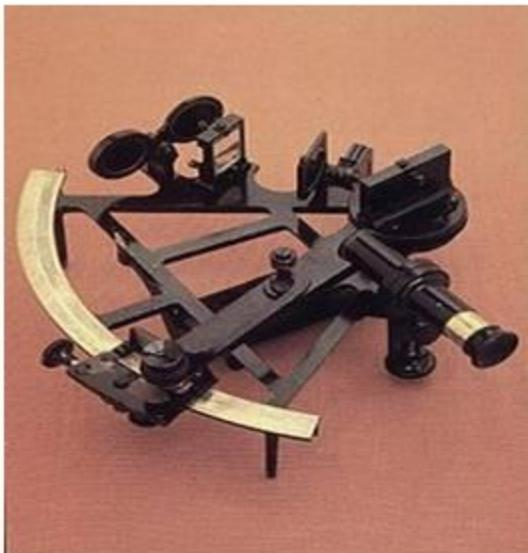
**Секстант**, секстан (от лат. *sextans* (род. п. *sextantis*) — шестой, шестая часть) — навигационный измерительный инструмент, используемый для измерения высоты Солнца и других космических объектов над горизонтом с целью определения географических координат той местности, в которой производится измерение
