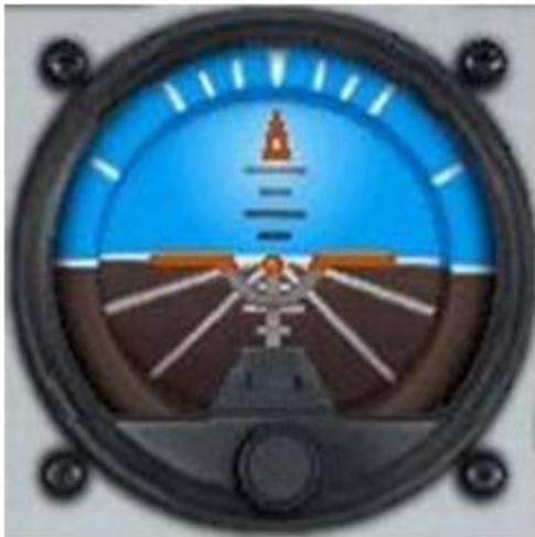
**Авиагоризонт** - прибор используется лётчиком для управления и стабилизации летательного аппарата в воздухе.
