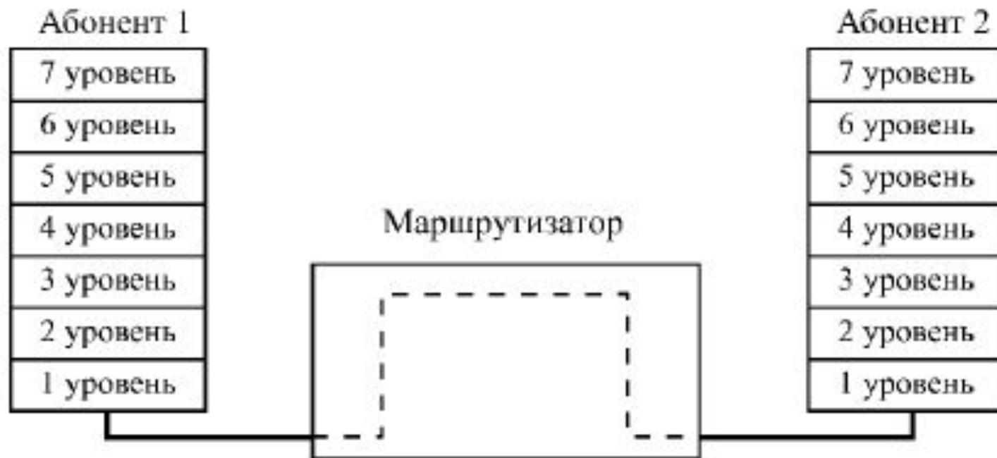
Функции маршрутизатора в модели OSI
