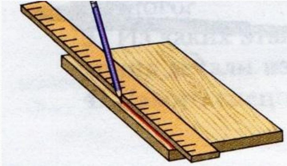
2. От базовой пласти рейсмусом размечают необходимую толщину заготовки
