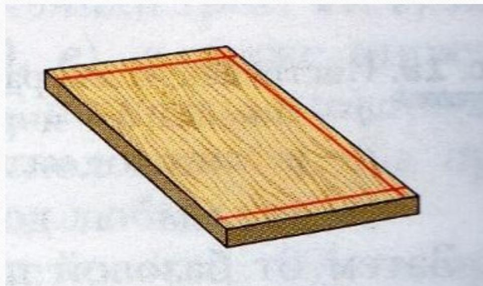
9. Размеры имеющегося в детали выреза размечают с помощью угольника
