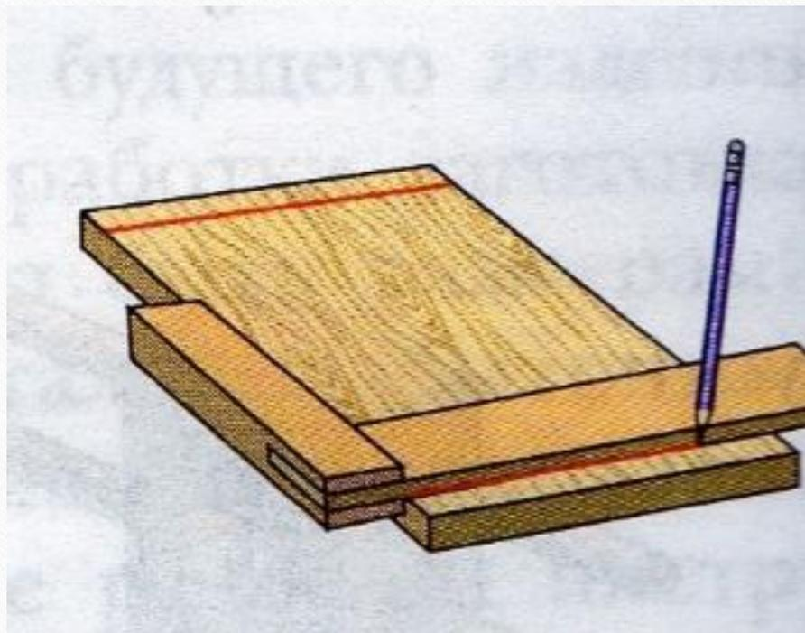
7. На обеих линиях по линейке отмеряют и отмечают карандашом ширину детали
