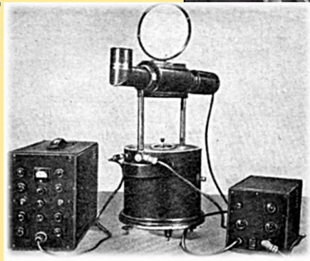
Ультразвуковой дефектоскоп Соколова
