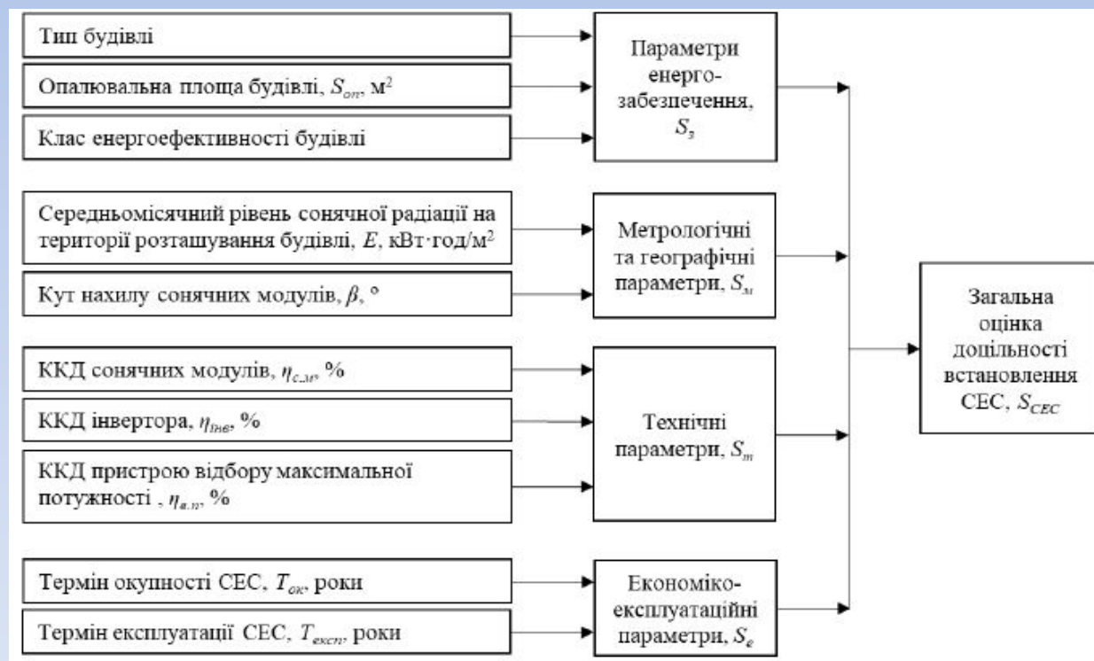
Рисунок 2.1 – Структурна схема нечіткої моделі для оцінювання доцільності встановлення СЕС
