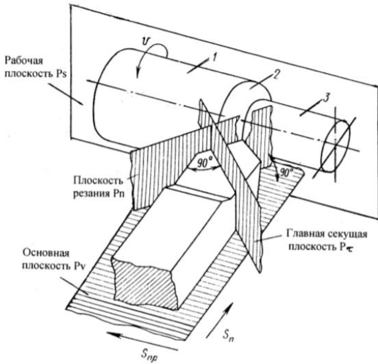
Углы в плане измеряются в основной плоскости. Сумма углов  $\varphi + \varphi_1 + \varepsilon = 180^\circ$ .
