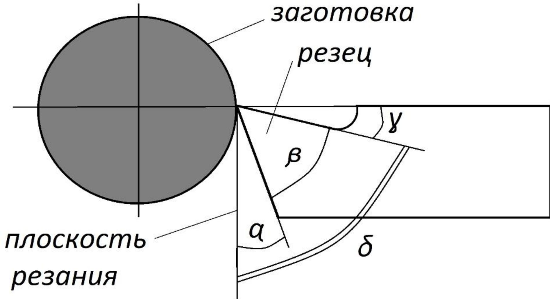
Вспомогательный задний угол  $\alpha_1$  – угол между вспомогательной задней поверхностью резца и плоскостью, проходящей через его вспомогательную режущую кромку перпендикулярно основной плоскости.
