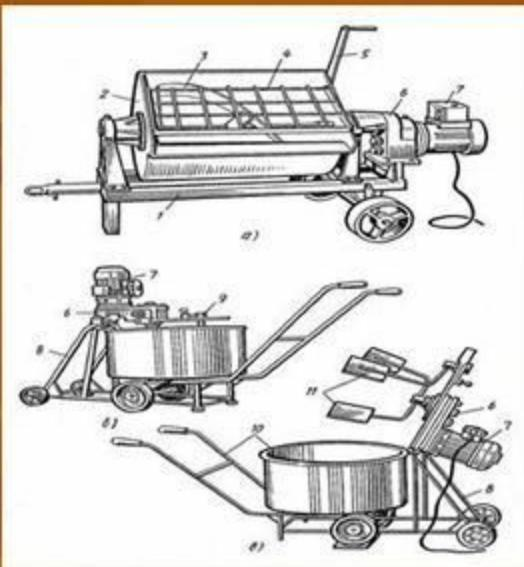
А) 1-тележка, 2-электродвигатель, 3-электрошкаф, 4-лопасть, 5-смесительный барабан, 6-ограждение загрузочного отверстия, 7-рукоятка.
