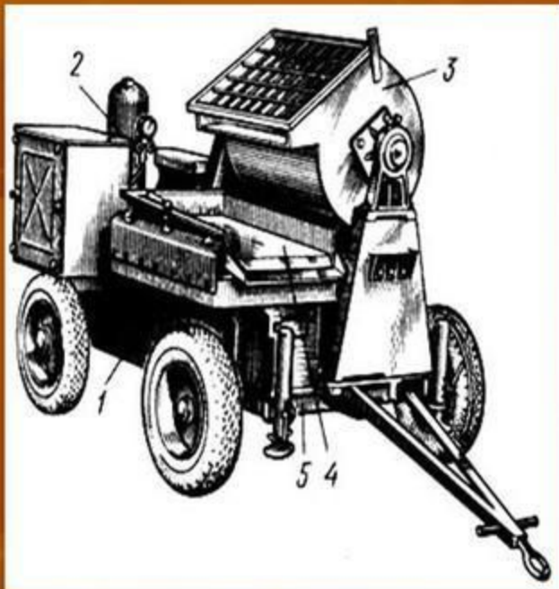
Штукатурный агрегат: 1 - бункер, 2 - растворонасос, 3 - растворосмеситель, 4 - виброрито, 5 - рама на пневмоколесном шасси
