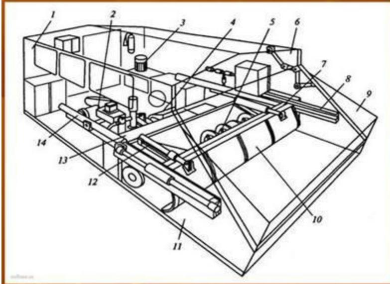
1-кузов, 2-поршневой растворонасос, 3-электродвигатель, 4-пульт управления силового оборудования, гидросистемы, системы водоснабжения, вентиляции и отопления, электрооборудования, 5-привод шнека, 6, 12- гидроцилиндр, 7, 14- каретки, 8-направляющие для перемещения каретки, 9-крышка бункера, 10-поворотный струг для перемешивания раствора, 11-приемный бункер вместимостью 4м.куб.13- накопительный бак
