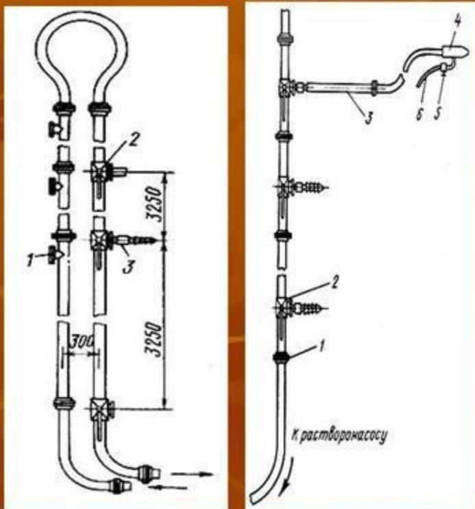
1-ревизия, фланцевое соединение звеньев, 2-трехходовой кран, 3-штуцер, 4-распылительная фарсунка, 5-воздушный вентиль, 6-воздушный шланг, 7- растворопровод
