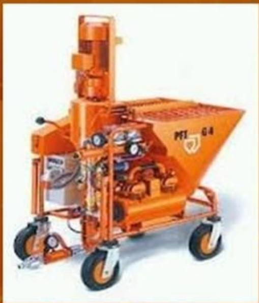
Этот агрегат способен приготовить 80 литров готового штукатурного раствора всего за 1 минуту таким образом эта техника повышает производительность штукатурных работ в 5 раз.
