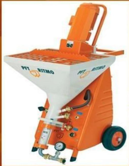
Аппарат для штукатурки имеет в своем составе емкость, в которую поступает вода и сухая смесь. Пропорции составляющих запрограммированы, поэтому раствор получается только правильной консистенции. В емкости происходит тщательное перемешивание раствора, он разрыхляется и насыщается кислородом. После смешивания раствор с помощью шланга наноситься на поверхность.
