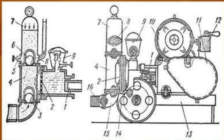
1-плунжер, 2-диафрагма, 3,6- всасывающий и нагнетательный клапаны, 7-компенсатор, 8-штуцер, 9-заливочно-предохранительное устройство, 10-электродвигатель, 11-механизм передачи, 12-переключатель, 13-тележка, 15- всасывающее колено, 16-патрубок.
