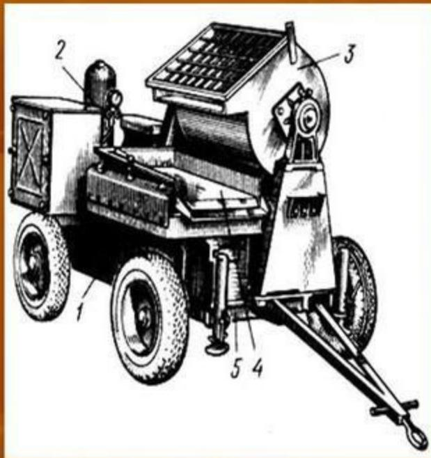
Штукатурный агрегат: 1 - бункер, 2 - растворонасос, 3 - растворосмеситель, 4 - вибросито, 5 - рама на пневмоколесном шасси
