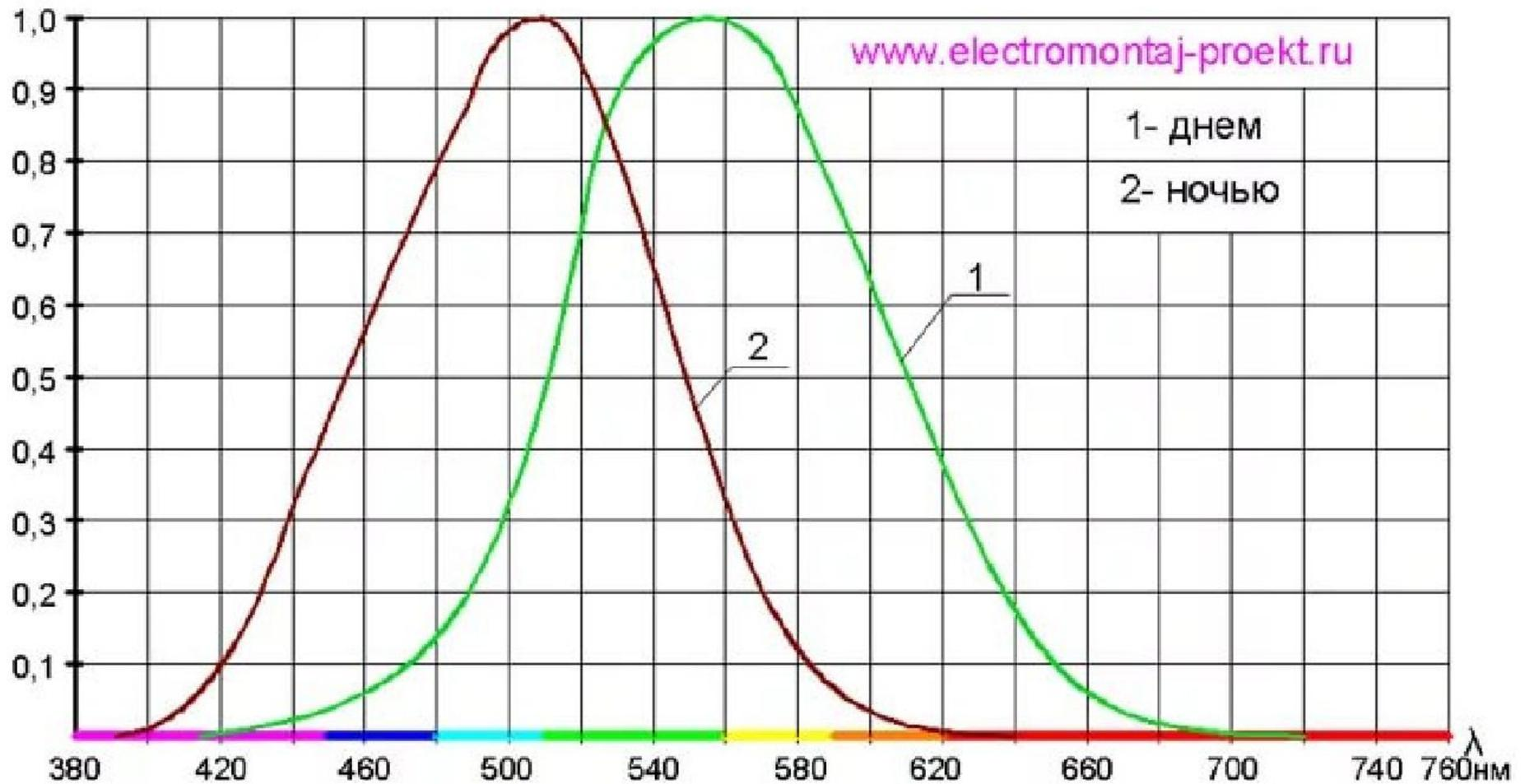
Рис. 1 Кривые относительной спектральной чувствительности глаза
