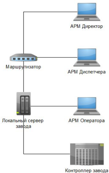
Схема построения локальной АСУ (коробочная версия)
