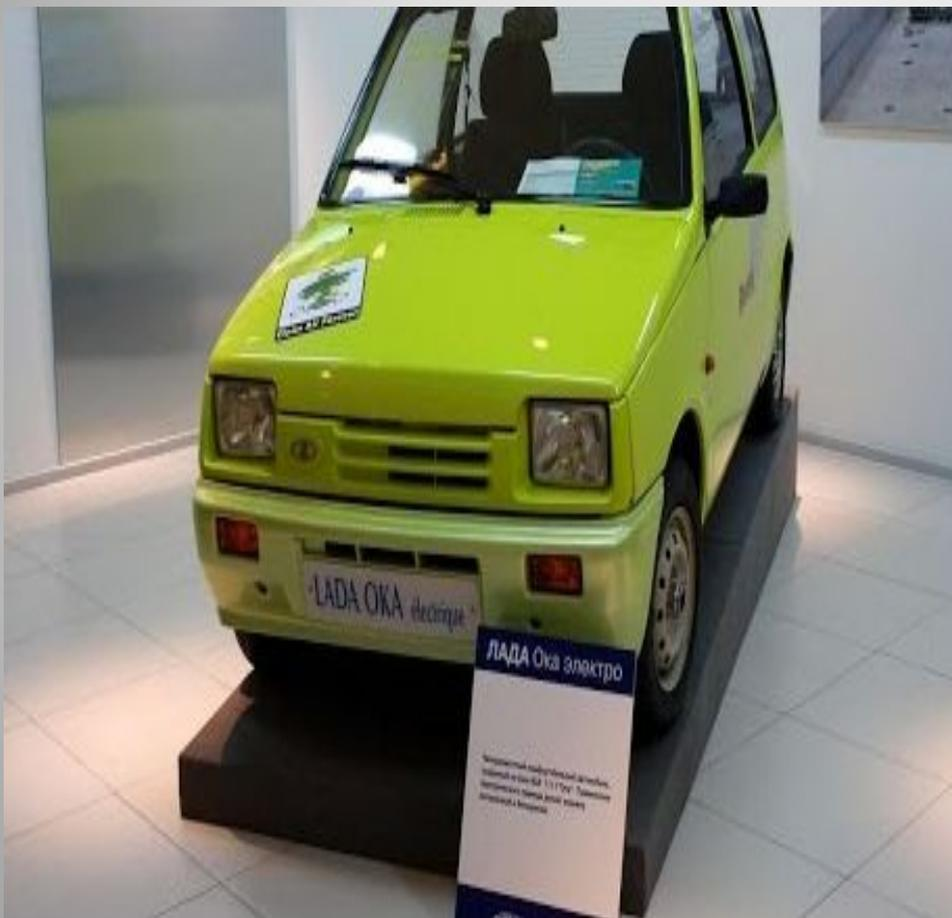
Экспериментальная мелкосерийная модель, с электродвигателем разработанная в 1992 году. Подвеска автомобиля отличалась более мощными пружинами из-за веса батарей в 315 килограмм. Запас хода при скорости 40 км/ч составлял 110 километров.
