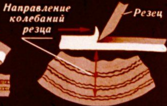
Звуковая канавка на диске граммофона (поперечная запись)
