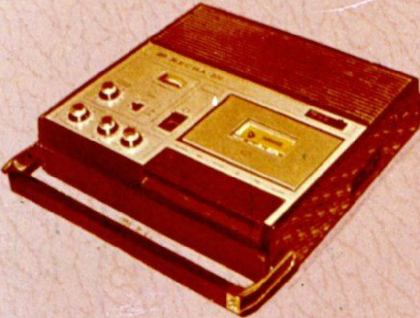
В бытовых магнитофонах записывающую и воспроизводящую головки заменяют одной—универсальной.
