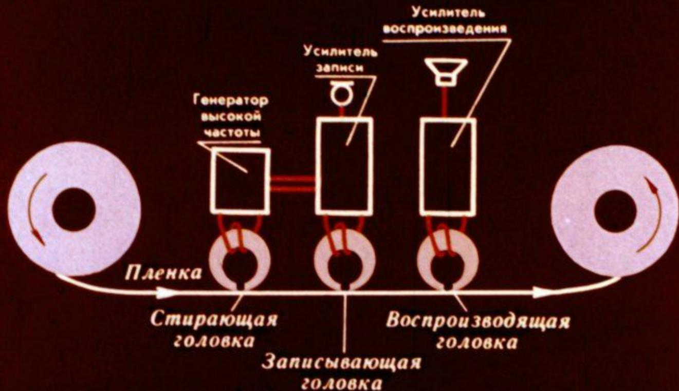
Для магнитной записи, воспроизведения и стирания применяют раздельные электромагниты — головки. На рисунке показана структурная схема магнитофона с тремя головками.
