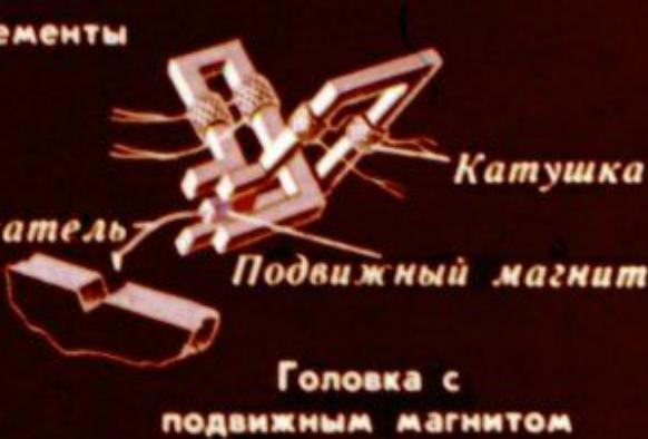
Для воспроизведения стереофонической грамзаписи применяют стереофонические звукосниматели (головки), основанные на различных физических явлениях. Каждый канал записи создает электрические колебания в разных электрических цепях. Эти электрические колебания после усиления поступают на громкоговорители, которые удалены друг от друга.
