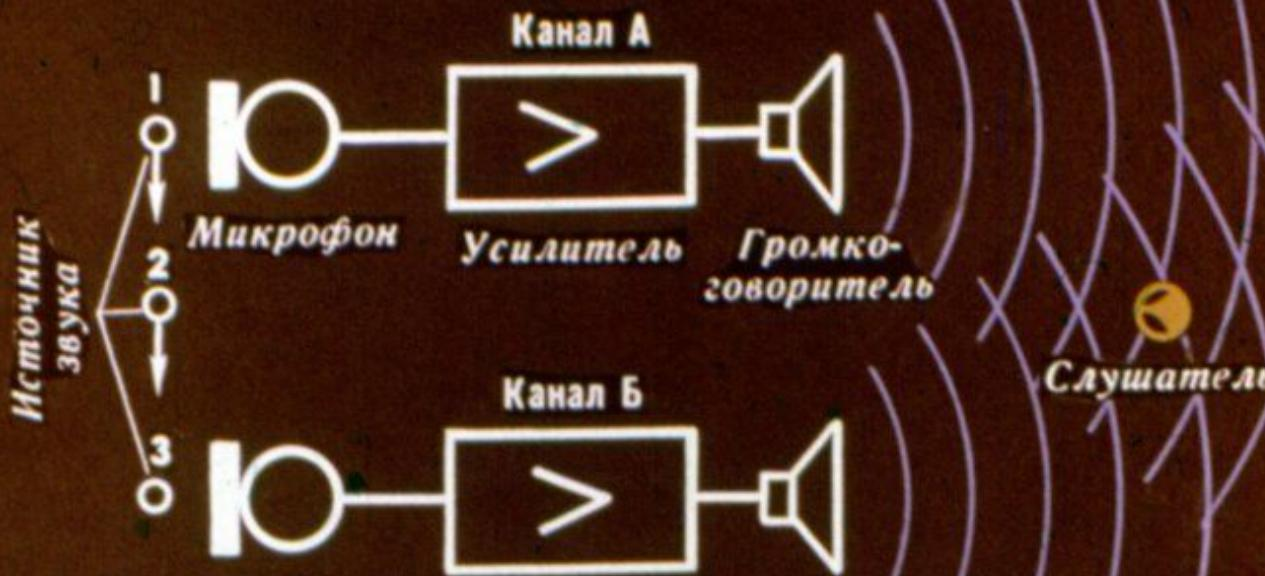
Принцип стереофонической двухканальной передачи звука. При перемещении источника звука из точки 1 в точку 2 и 3 будет происходить перераспределение звукового поля в помещении, где расположен слушатель. Это позволит ему судить о перемещении источника звука. Создается впечатление объемного звучания.
