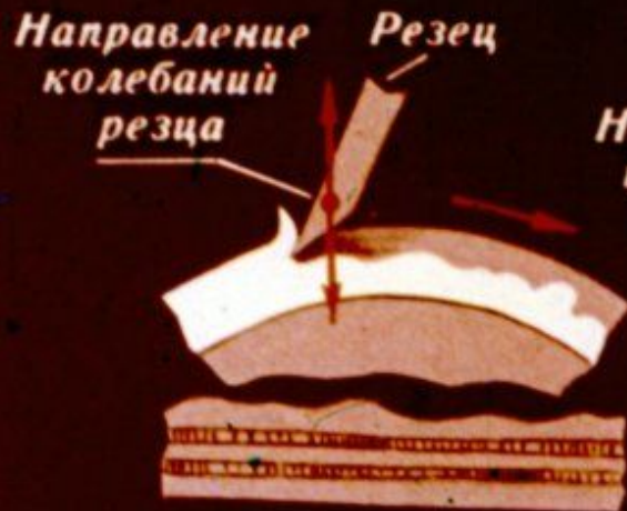
Звуковая канавка на валике фонографа (глубинная запись)
