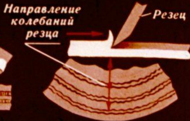
Звуковая канавка на диске граммофона (поперечная запись)
