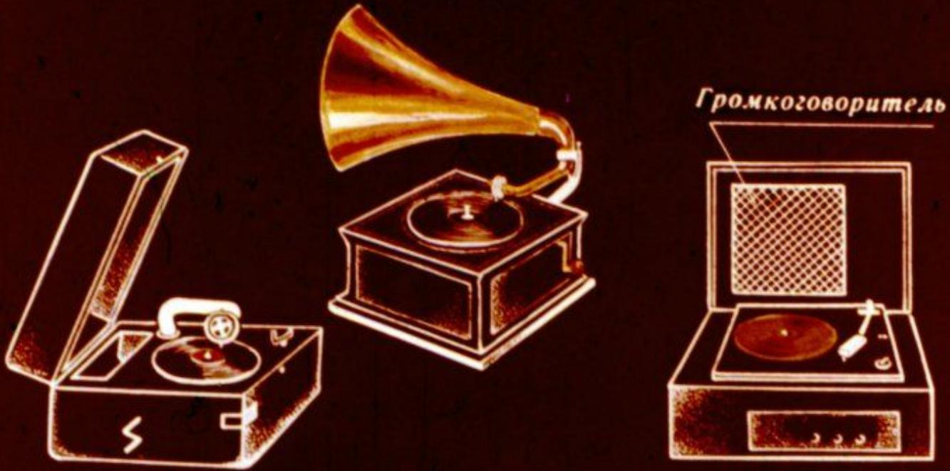
Ручной привод в граммофонах сначала был заменен пружинным, а потом электрическим. На смену большому рупору пришел электронный усилитель с громкоговорителем. Это позволило создать компактную конструкцию переносного проигрывателя с регулятором громкости звука.
