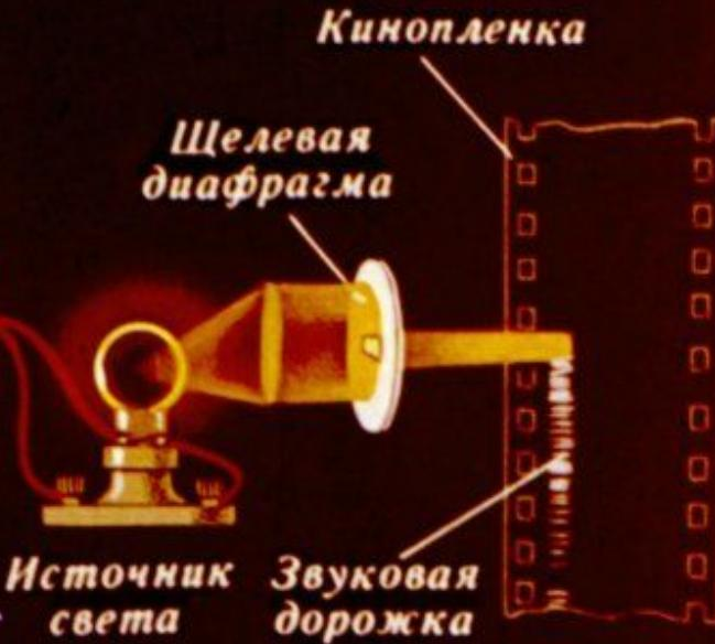
Возможна иная принципиальная схема оптической записи звука. Если специальную лампу питать токами звуковой частоты, то ее световой поток будет изменяться в соответствии со звуковыми колебаниями и на движущейся пленке возникнет звуковая дорожка переменной плотности.
