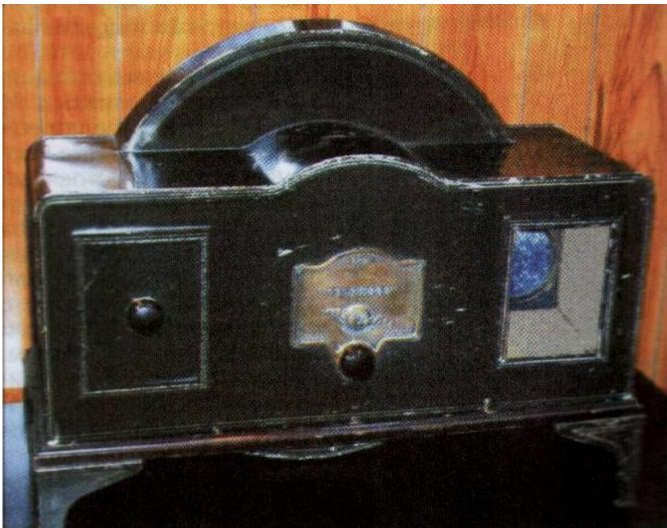
Телевизор сконструированный Д.Бердом в 1930 году. Кожух в задней части корпуса сделан для защиты диска Нипкова.
