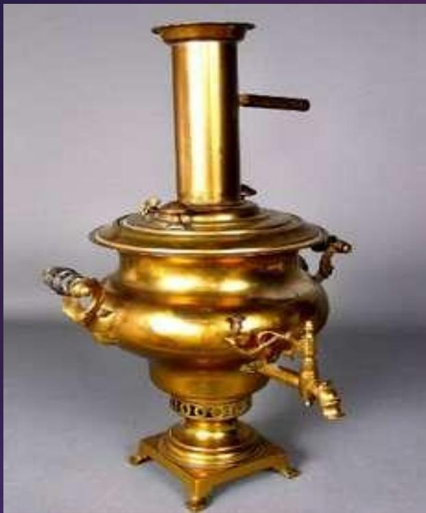
**В трубу, которая находится внутри самовара, засыпали сосновые шишки или сухие чурки, древесный уголь, поджигали их лучиной, раздували огонь сапогом. Вскоре вода в самоваре закипала. Наверху у самовара имеется приспособление для установки заварного чайника.**
