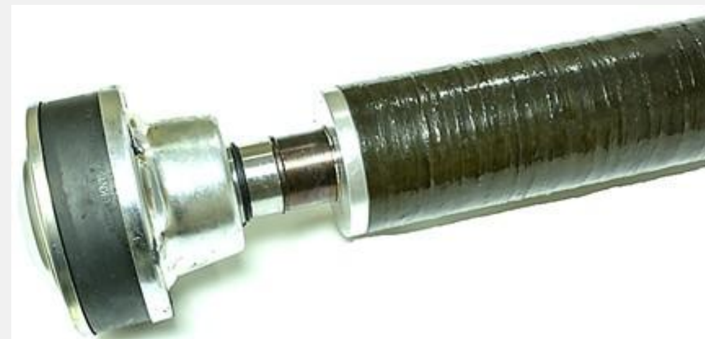
Вал из углеродного волокна, изготовленный методом намотки
