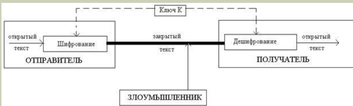
Рис. Функциональная схема симметричной криптосистемы
