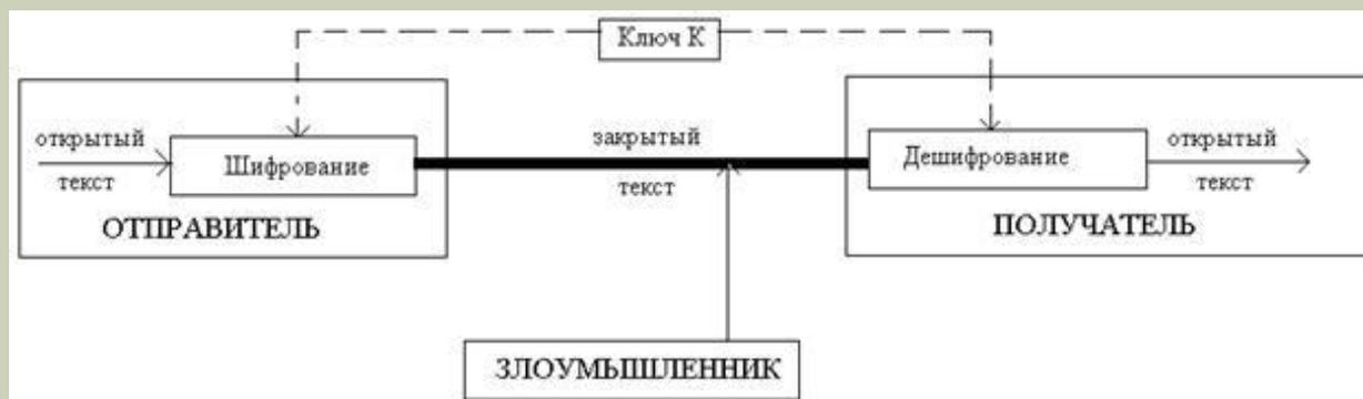
*Рис. Функциональная схема симметричной криптосистемы*
