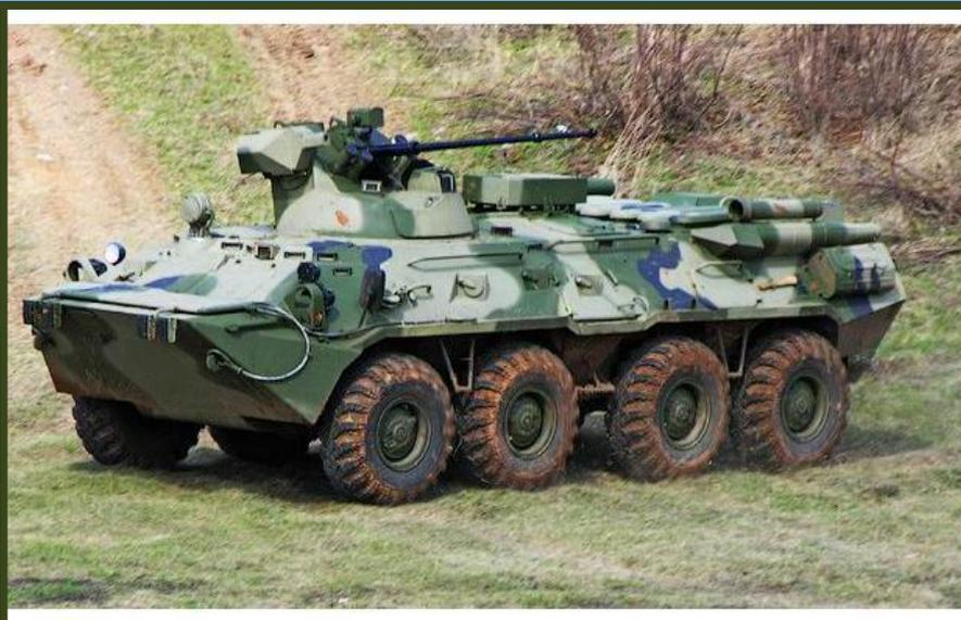
**БТР-80А** и **БТР-82А** — боевая колесная плавающая машина, предназначенная для транспортирования мотострелковых подразделений и огневой поддержки их на поле боя, ведения боя из машины.
