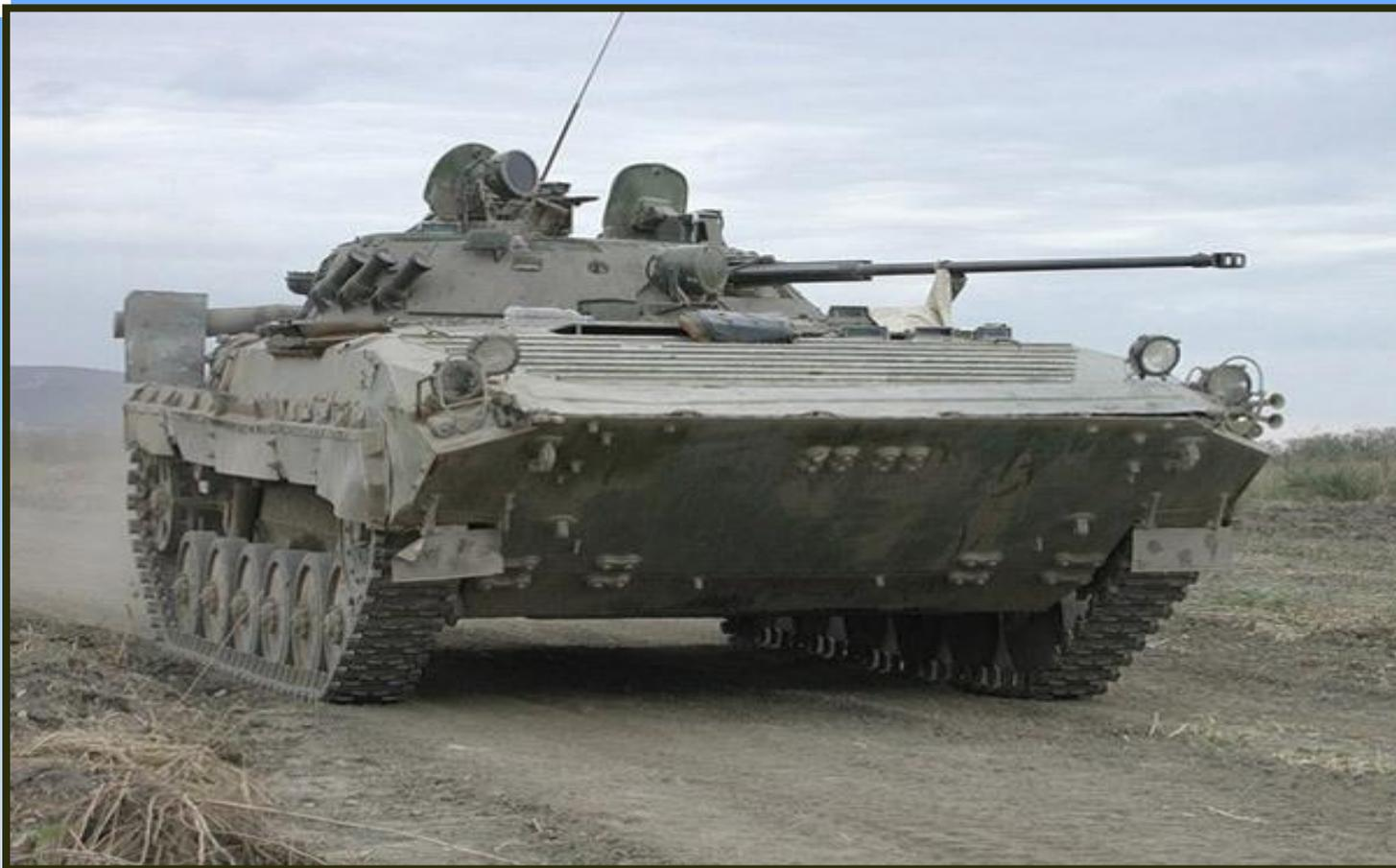
Боевые машины пехоты БМП-2. Вооружена 30-мм автоматической пушкой 2А42 (500-выстрелов), пулемётом ПКТ (2000) и противотанковым ракетным комплексом "Фагот" или "Конкурс" для борьбы с танками (4-ПТУР).
