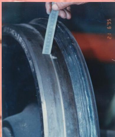
Наплавка гребней восстанавливает их геометрию и повышает износостойкость в **3-5 раз** за счет применения специальной сварочной проволоки
