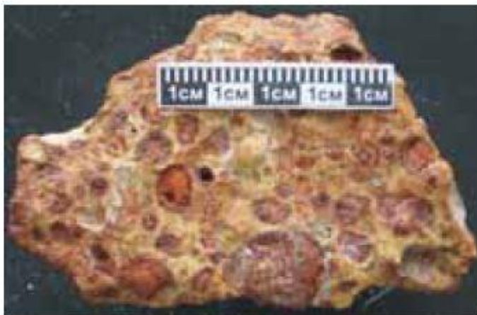
ж-и) бокситы осадочные с бобовой и оолитовой структурой
