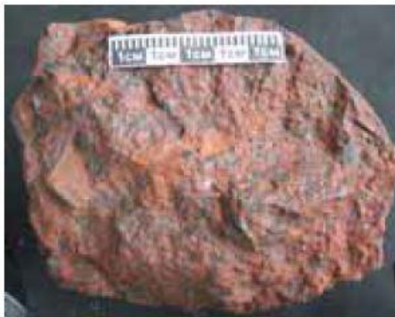
ж-и) бокситы осадочные с бобовой и оолитовой структурой
