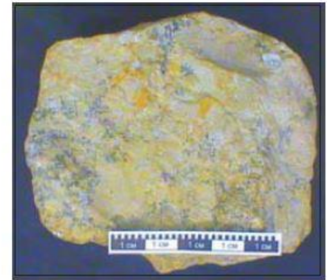
е) марганцевая карбонатная руда с дендритами гидроксидов марганца по трещинам
