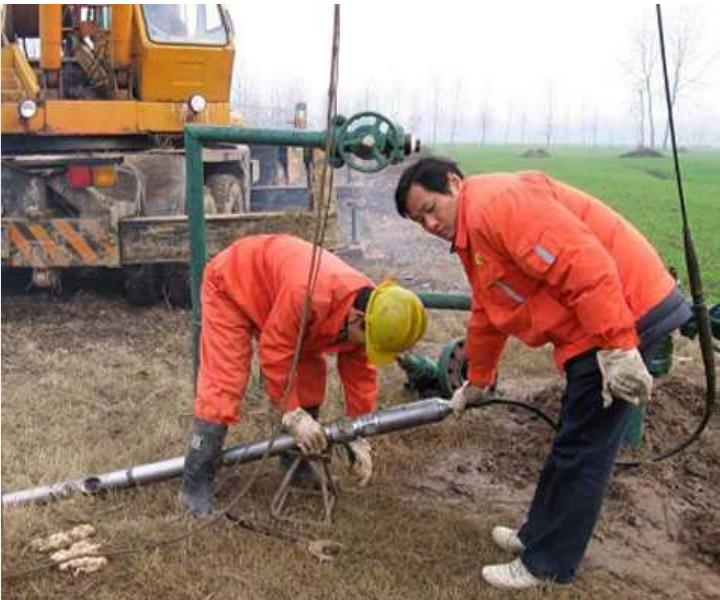
**Проведение показательных работ в Китае локатором ультразвуковым акустическим скважинным Сканер-2000 НПО ПОИСК. Исследование батарейной скважины, при аварийном состоянии рабочих колонн.**
