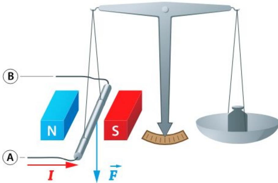
Расположим прямолинейный проводник  $AB$  в магнитном поле так, как изображено на иллюстрации 1, тогда силу  $F$ , действующую на него, можно измерить посредством гирек. В ходе этого опыта было выявлено, что сила зависит непосредственно от магнитного поля, длины проводника  $l$  и силы тока  $I$  в нём.
