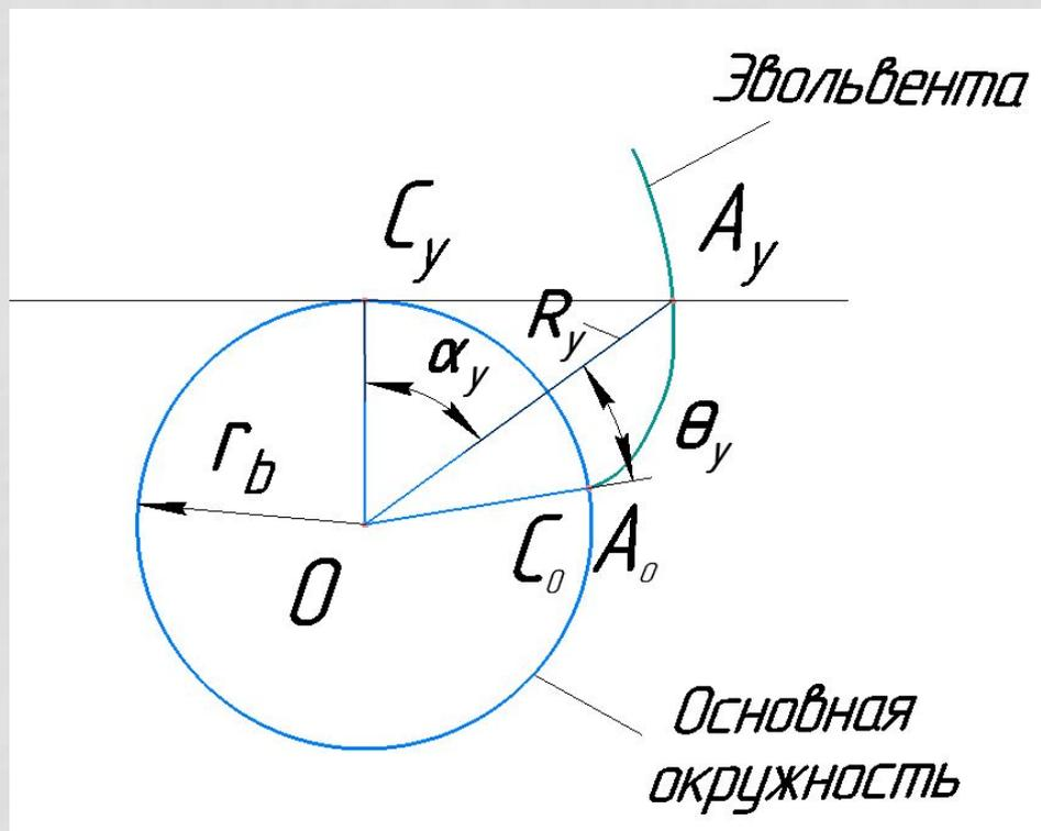
Для определения полярного угла  $\theta_y$  сначала выразим длину дуги основной окружности через её радиус и центральный угол:
