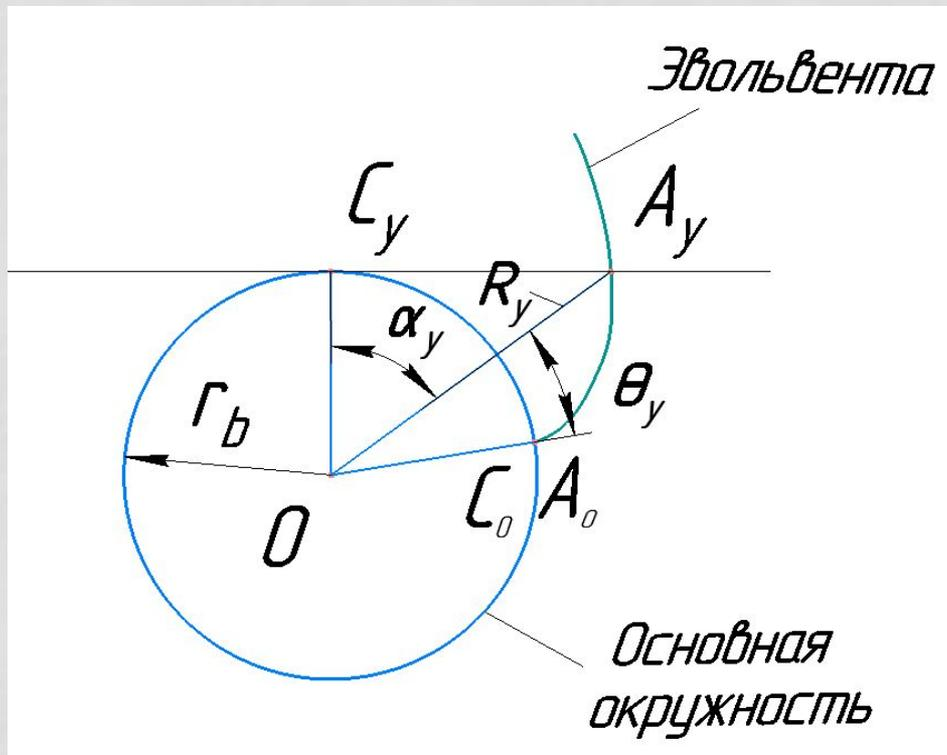
Положение произвольной точки  $A_y$  эвольвенты в полярной системе координат определяется двумя координатами относительно её начального радиуса-вектора  $OA_0$  (или  $OC_0$ ): длиной радиуса-вектора  $R_y$  и углом  $\theta_y$ . Радиус-вектор  $R_y$  определим из прямоугольного треугольника  $OA_yC_y$ :
