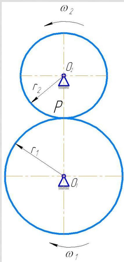
Рассматривая элементы теории зубчатых зацеплений, обратимся к простой зубчатой передаче, состоящей из двух звеньев 1 и 2 в виде цилиндрических зубчатых колес, с вращательными кинематическими парами  $O_1$  и  $O_2$ , которыми они связаны со стойкой, а также высшей парой  $P$ , в которой и происходит соприкосновение звеньев.
