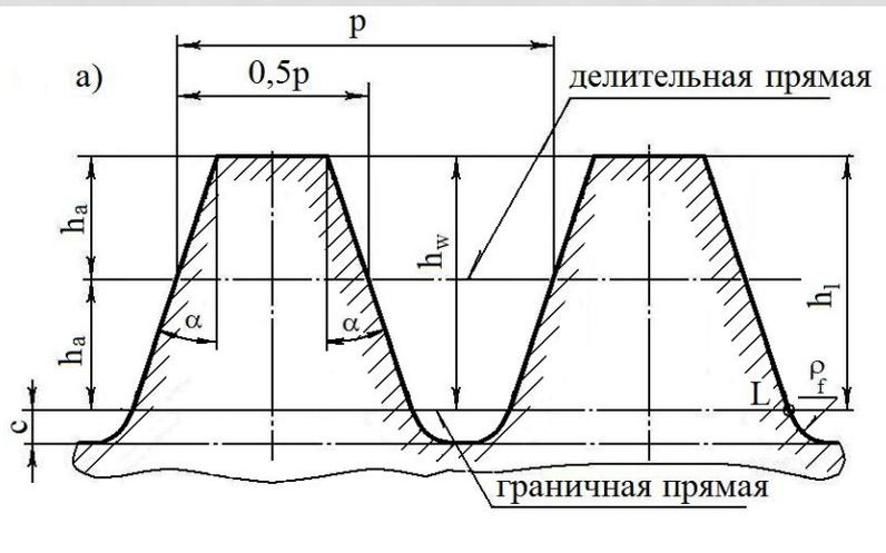
**Теоретический исходный контур** – плоская фигура, геометрия которой определена стандартом - ГОСТ 13755-81 для колес с модулем  $m$ , равным или более 1 мм и ГОСТ 9587-81 для колес с  $0,1 \leq m < 1 \text{ мм}$
