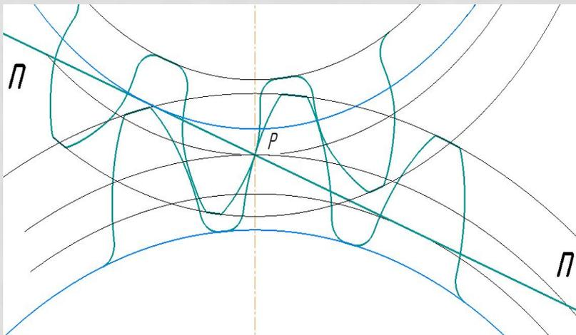
Нормаль  $n-n$ , проведенная через полюс зацепления  $P$ , образует **линию зацепления** – геометрическое место точек последовательного соприкосновения пары зубчатых профилей, принадлежащее неподвижной плоскости.
