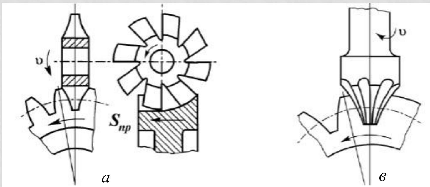
Схемы нарезания зубчатых колес модульными фрезами:
