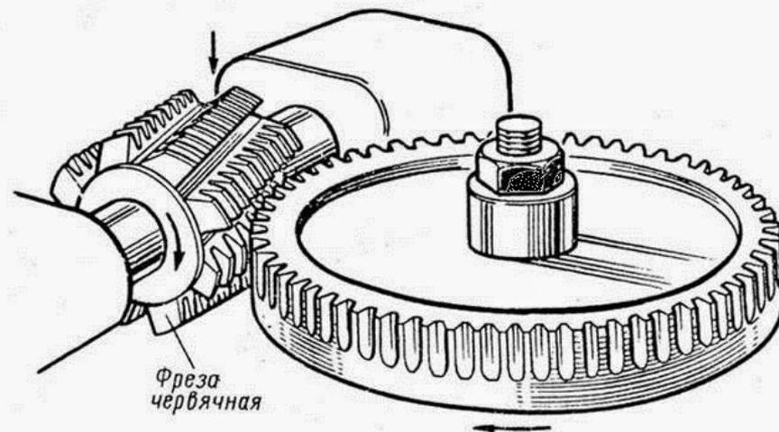
*в* – нарезание зубчатого колеса червячной фрезой.
