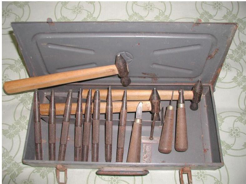
При работе чекан держат в левой руке тремя пальцами, опираясь безымянным пальцем (мизинец остаётся свободным). Локоть должен быть на весу, что обеспечивает подвижность руки. Чекан держат не строго вертикально, а слегка наклоняют назад, чтобы его рабочая поверхность (бой) была косо приподнята и вследствие этого при ударе молотком постоянно двигалась вперёд. В правой руке держат молоточек, которым наносят лёгкие частые удары по чекану, продвигая его.
