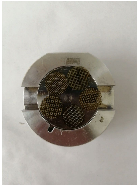
Рисунок 1 - Вырезанные и протруструрированные на лазере FMark 20RL электроды
