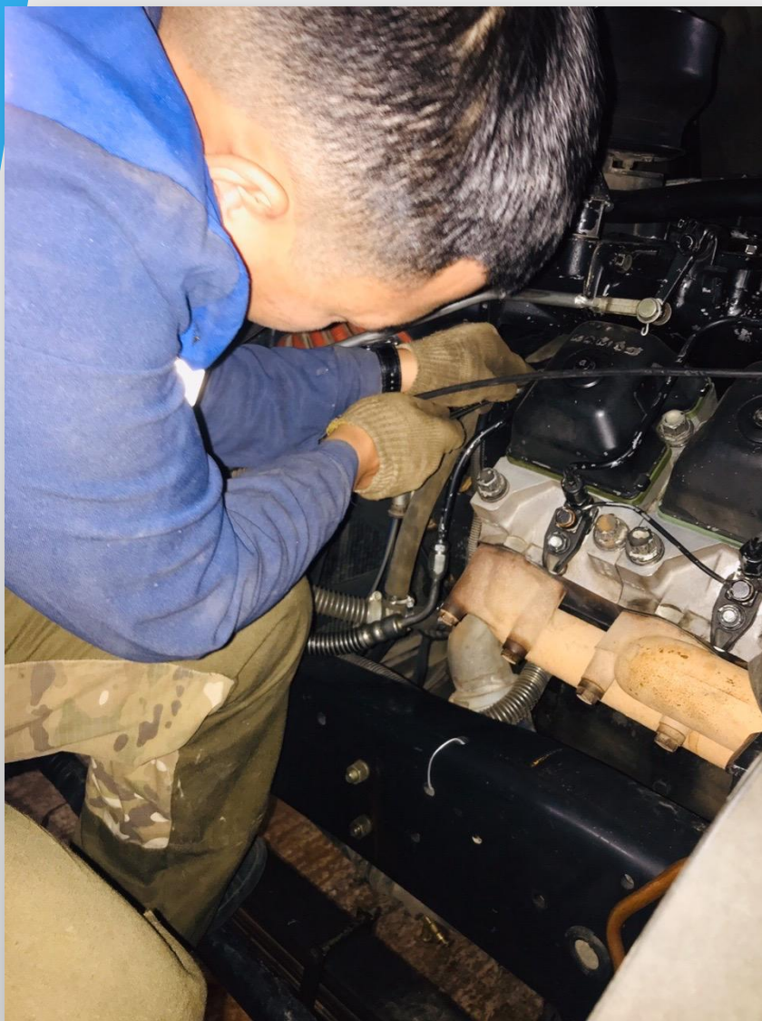
Снятие водяного насоса
