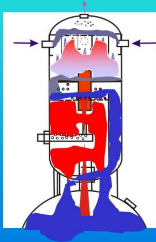
переливной тарелки, барботажного устройства. Производительность колонки 1600 т/ч деаэрированной воды.
