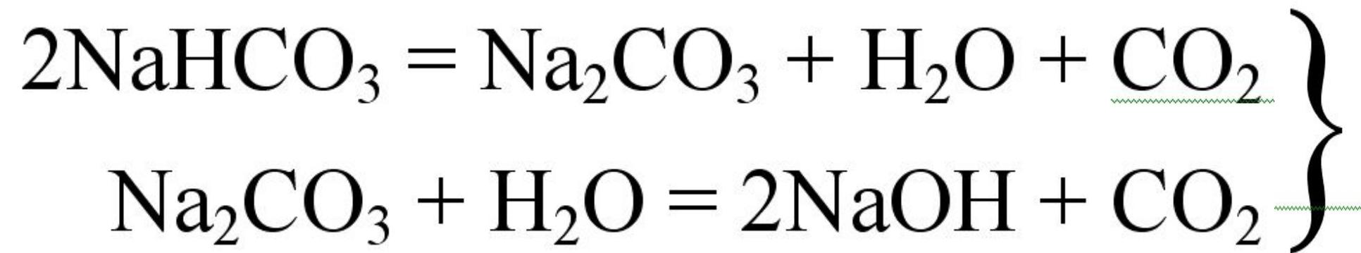
Поэтому , для хорошей дегазации воды следует нагреть воду до кипения с непрерывным образованием некоторого количества пара и его отводом из термического деаэрата. Отвод пара позволяет не допускать над уровнем воды сколько-нибудь заметного парциального давления удаляемого газа, что необходимо, исходя из условия уравнения (3).
