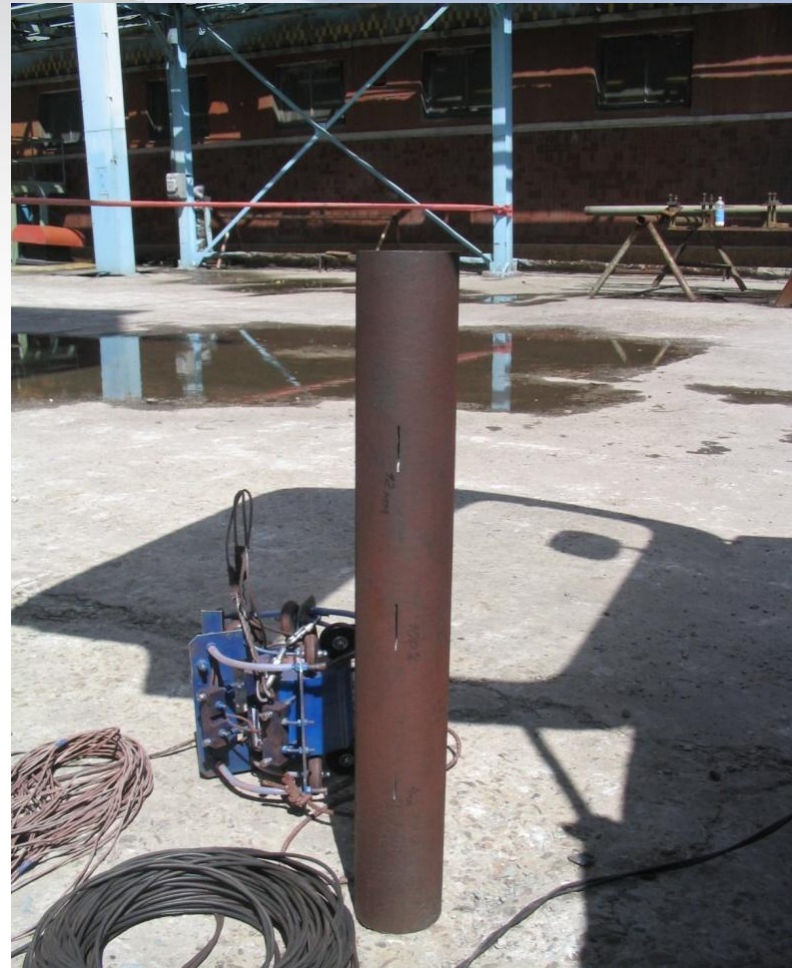
Калибровочный образец толстостенной трубы ( \varnothing 102 \times 15 ) и накладной вихретоковый преобразователь
