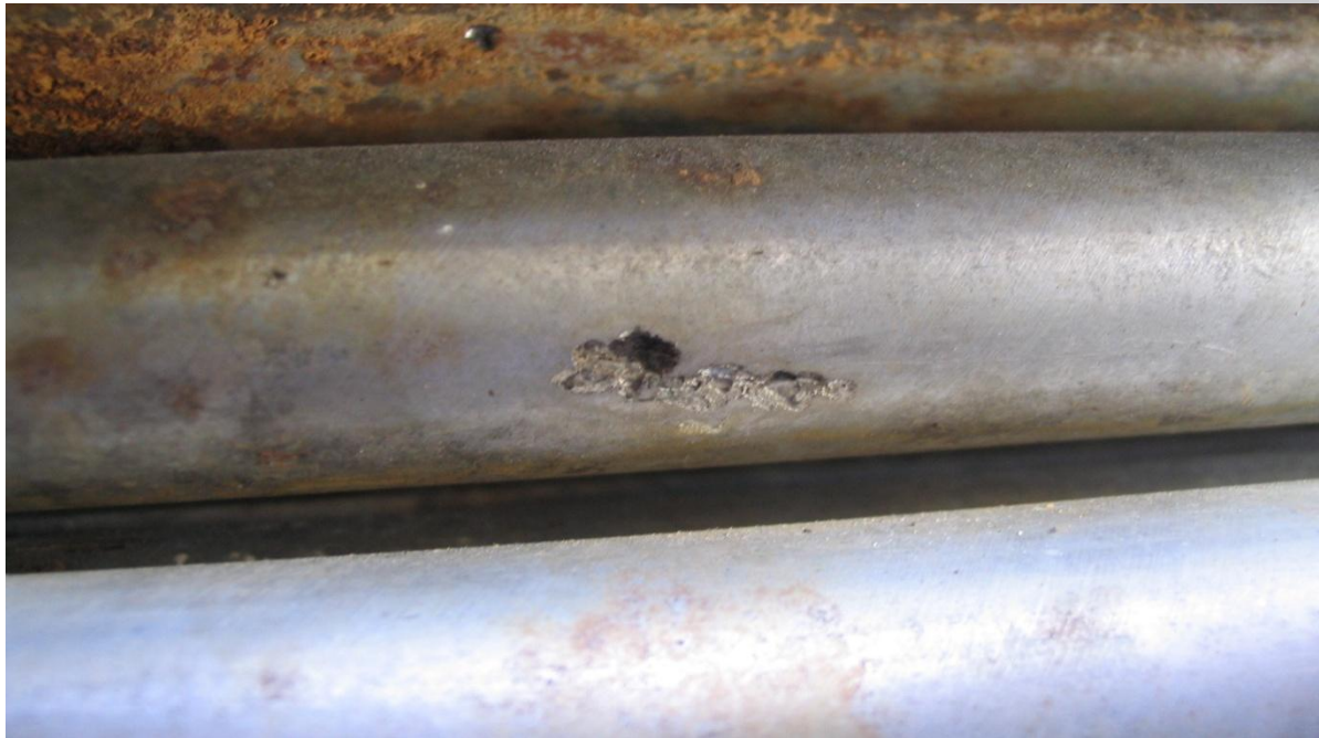
Питтинговая язва глубиной до 50% от толщины стенки (материал 12Х18Н10Т)
