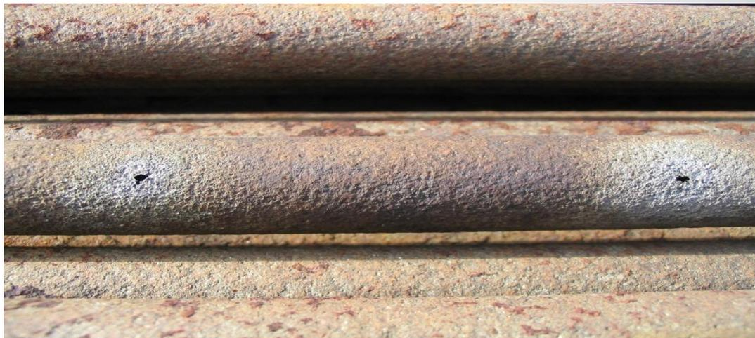
*Сквозные коррозионные поражения стенки трубы по внутренней поверхности (материал Ст. 15ХМ)*
