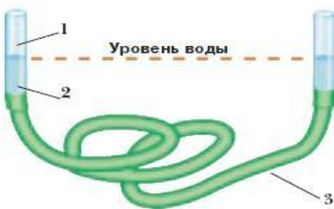
**В сообщающихся сосудах любой формы и сечения поверхности однородной жидкости устанавливаются на одном уровне (если давления воздуха над жидкостью одинаково ).**
