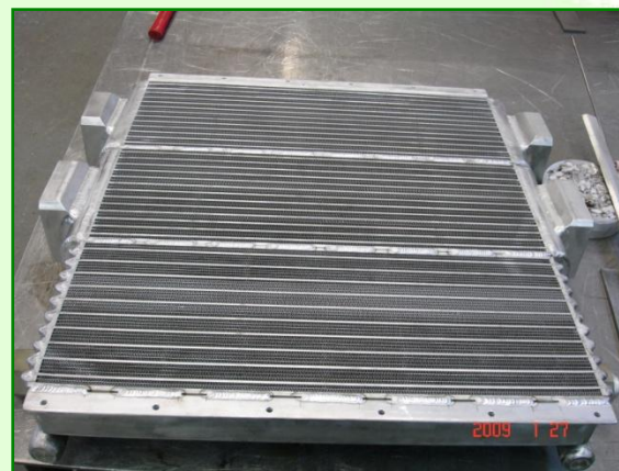
Трёхсекционный перекрестноточный ПРТ
