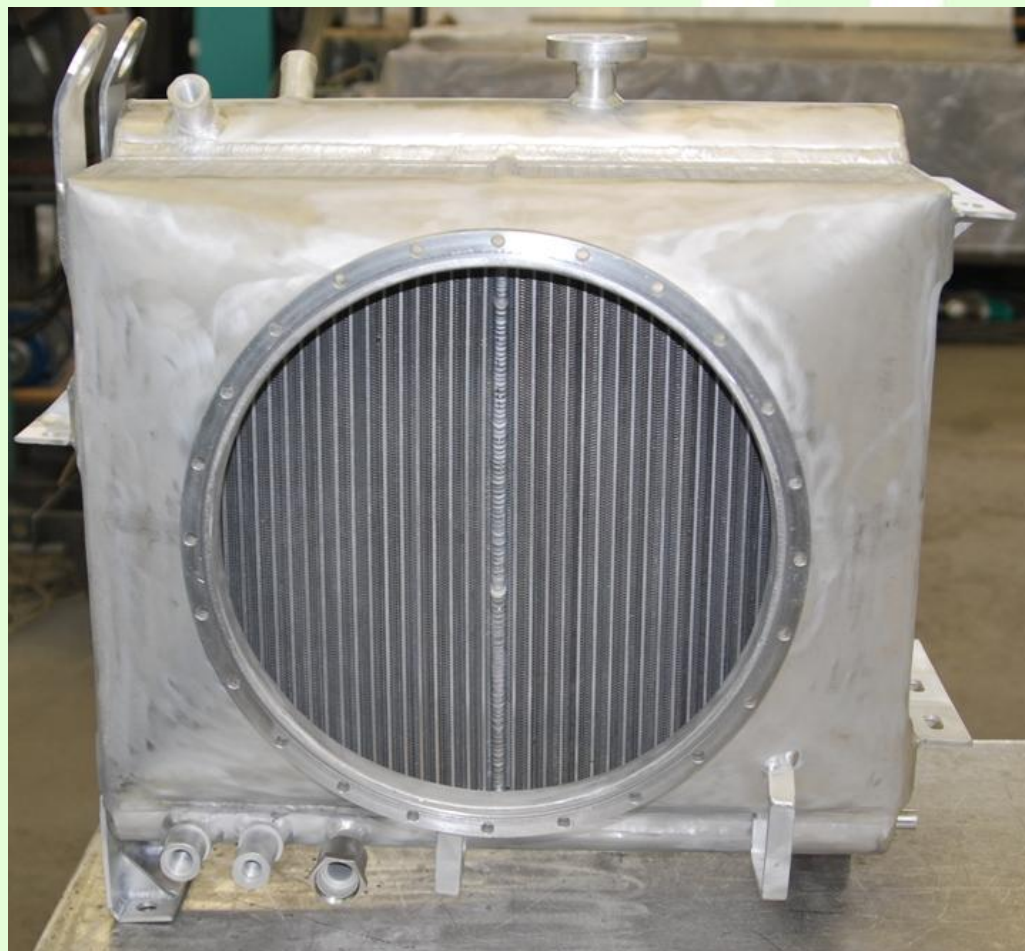
Фреоновый конденсатор авиационной системы кондиционирования воздуха
