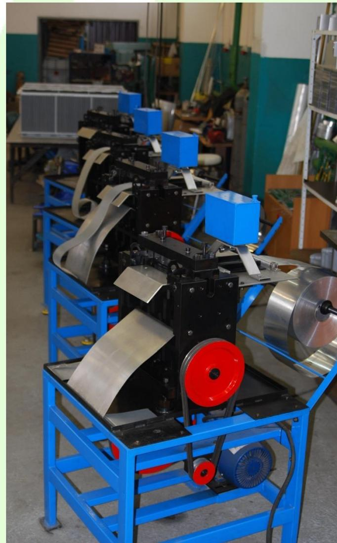
Оборудование для гофрирования вторичных поверхностей (насадок)
