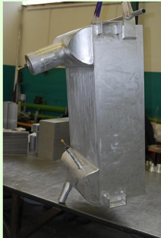
Конденсатор-испаритель криогенной воздуходелительной установки
