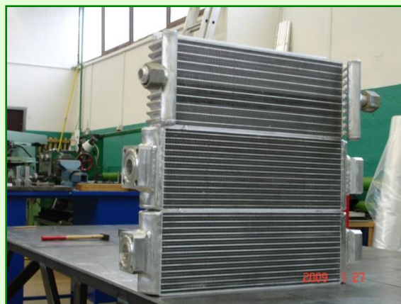
Трёхсекционный перекрестноточный ПРТ
