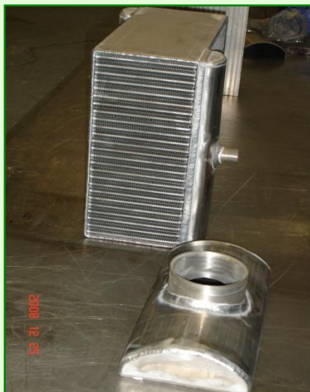
Теплообменная матрица с готовым для приварки коллектором с патрубком
