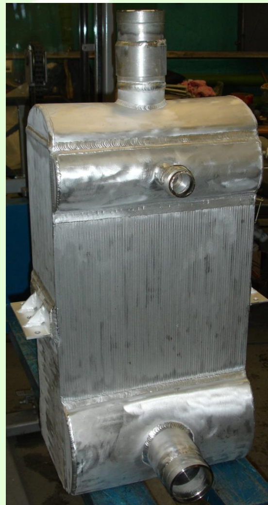
Теплообменник для переохлаждения жидкого азота газообразным неоном
