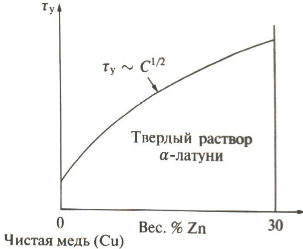
Рис. 10.1. Упрочнение кристалла путем образования твердого раствора
