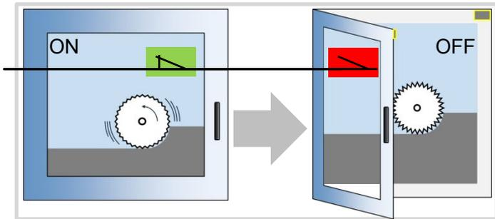
Вверху, справа: надежное определение открытия двери, затруднённый доступ к компонентам – предотвращение их саботажа
