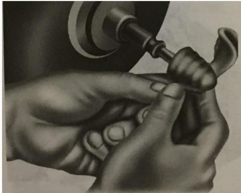
**Рис. 7.15.** Положение рук и протеза при шлифовании фильцем.
