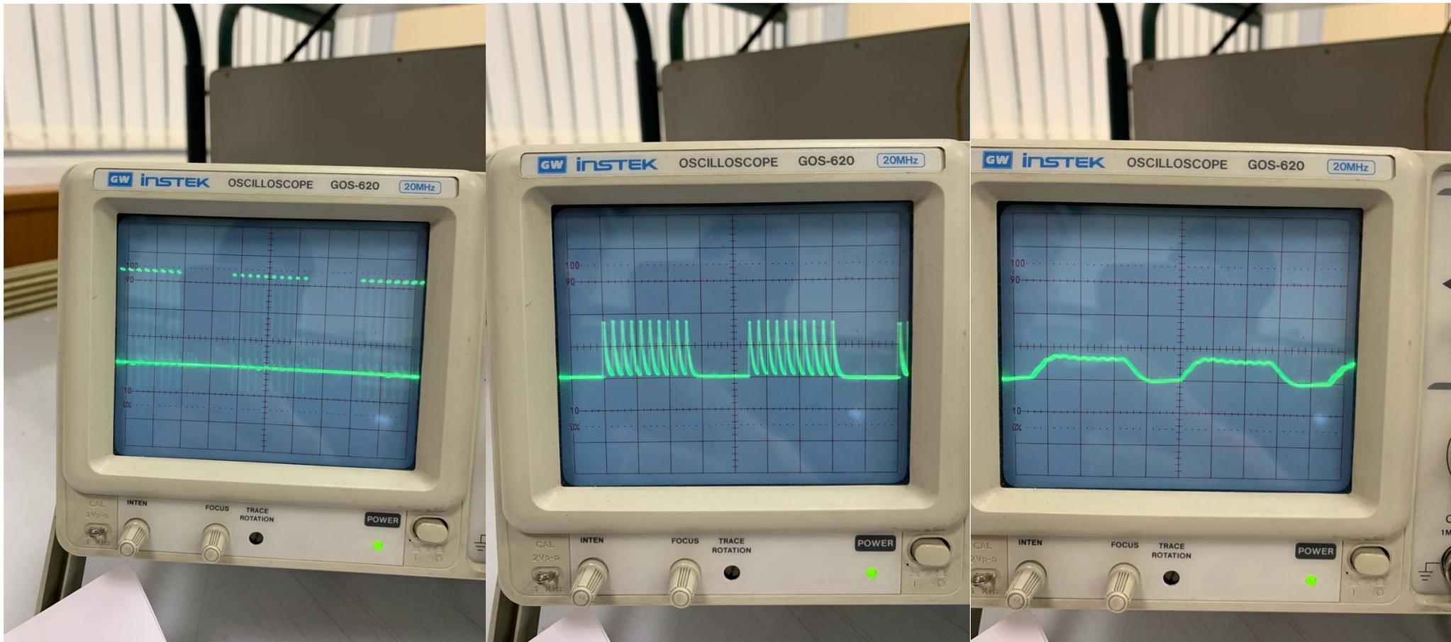
Осциллограмма дискретного прямоугольного импульса из 5-ти отсчётов и результаты восстановления с помощью фильтров  $\Phi 1$  и  $\Phi 2$ .
