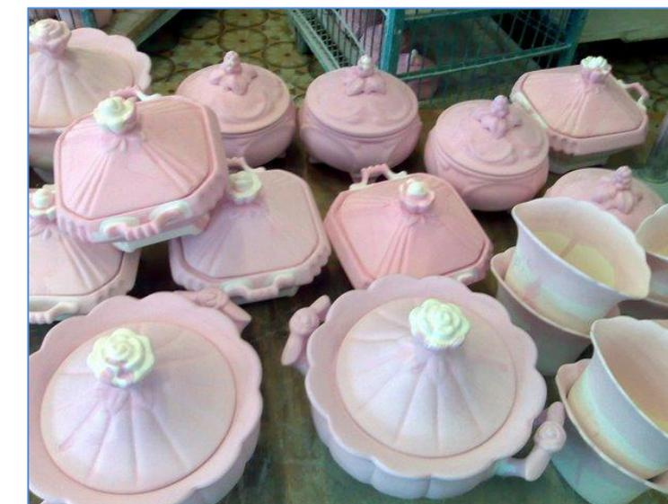
После первого обжига изделия проходят «фуксиновый контроль»: заготовки опускают в специальный розовый нестойкий раствор. Это даёт возможность проверить качество керамических изделий, делает заметными мелкие трещинки.
