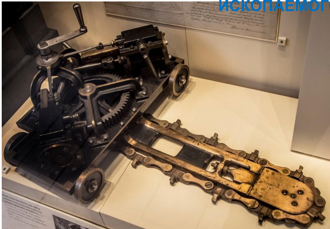
Врубовая баровая машина Gartscherrie производства William Baird с ручным приводом
