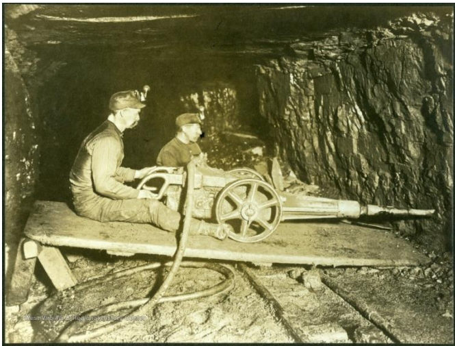
Перфораторная врубовая машина с пневмоприводом Sullivan
