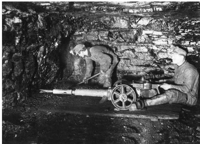
Перфораторная врубовая машина Sullivan с пневмоприводом 1900 г.
