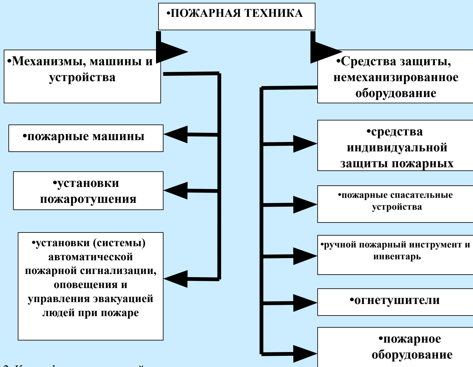
Рис. 2. Классификация пожарной техники
